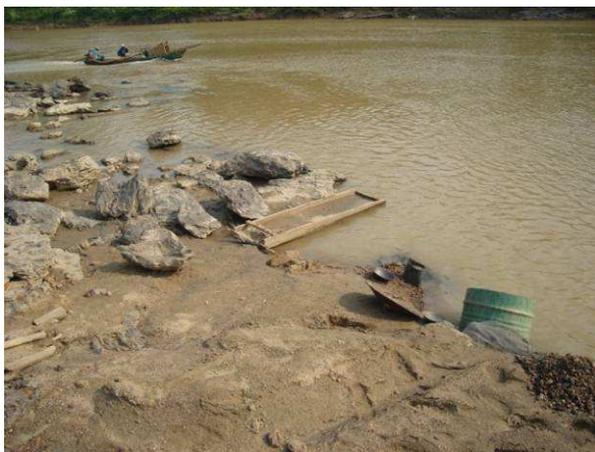
**Foto 8.3 -** Caixa encarpada utilizada na lavagem do material mineralizado.
