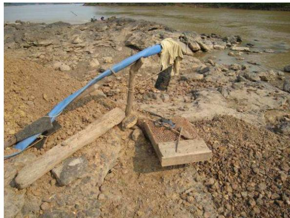
**Foto 8.2:** Mangueira utilizada para lavagem do material mineralizado.
