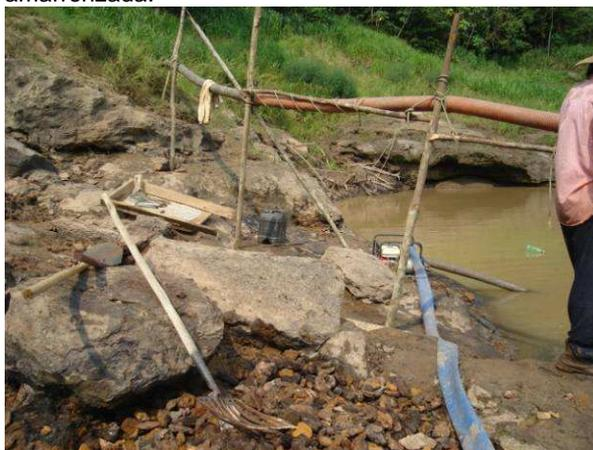
**Foto 1.4:** Mangueiras de água utilizadas no bombeamento para a porção superior do barranco.
