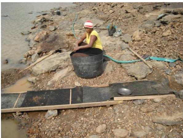
**Foto 7.1** – Caixa encarpeta utilizada na lavagem do material mineralizado.
