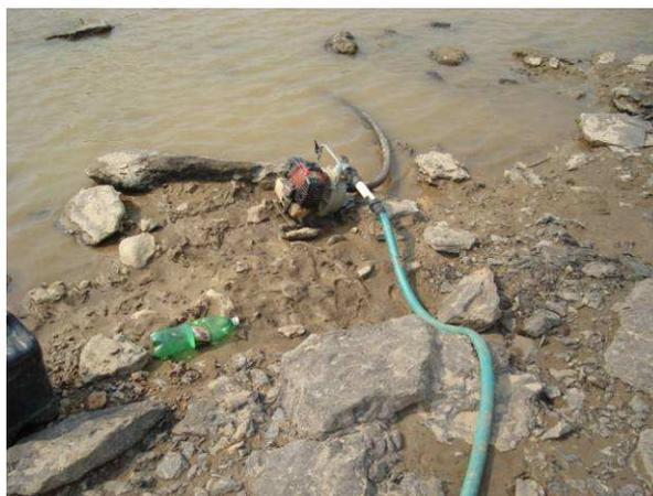
**Foto 7.2:** Motobomba utilizada para lavagem do material mineralizado.
