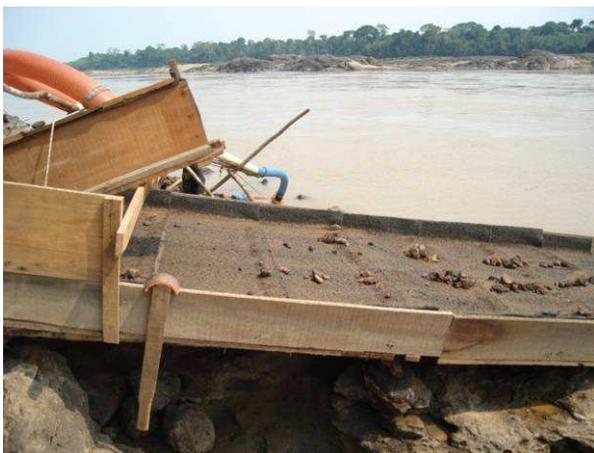
**Foto 2.3** – Caixa encarpada utilizada para lavagem do material mineralizado.
