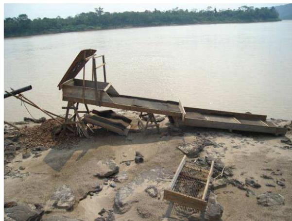
**Foto 6.2:** Caixa encarpada utilizada para lavagem do material mineralizado.**Ponto 7 – Laudo V82**
