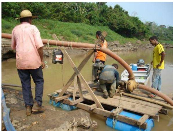
**Foto 1.3:** Bomba de água utilizada para a moagem e lavagem do material explorado.
