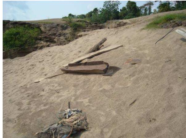
**Foto 4.2:** Caixa de zinco utilizada para lavagem do material mineralizado.
