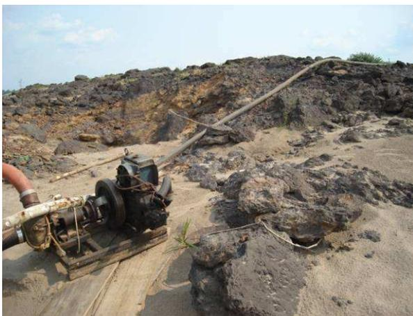
**Foto 6.1:** Bomba utilizada quando em operação a lavagem do material mineralizado.
