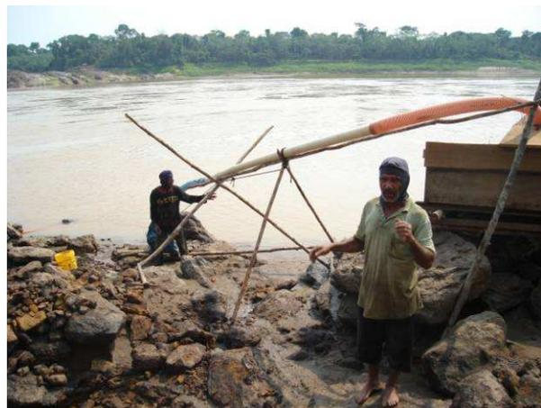
**Foto 2.2:** Mangueiras de bombeamento de água para lavagem do material na caixa encarpada.
