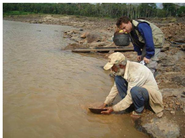
**Foto 7.4** – Processo de bateamento do material já lavado.
