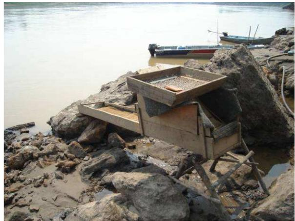
**Foto 3.2:** Caixa encarpetada utilizada para lavagem do material mineralizado.
