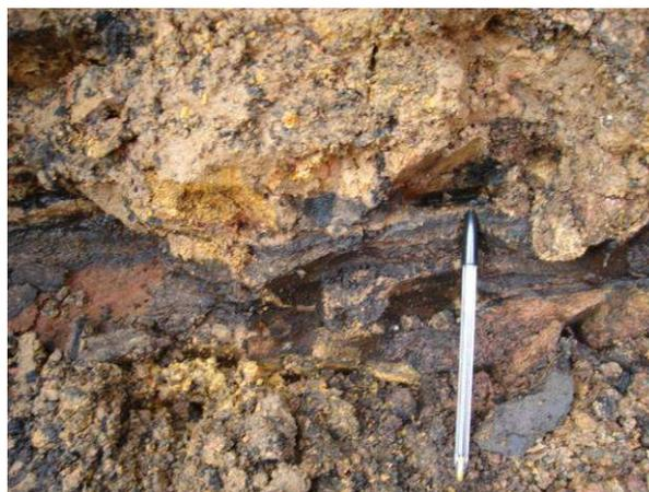
**Foto 1.2:** Detalhe do material mineralizado. A camada escura possui teor consideravelmente maior em relação as demais de coloração clara. O material mineralizado de coloração escura corresponde a intercalações milimétricas de material siltoso rico em matéria orgânica, e material arenoso de coloração amarronzada.
