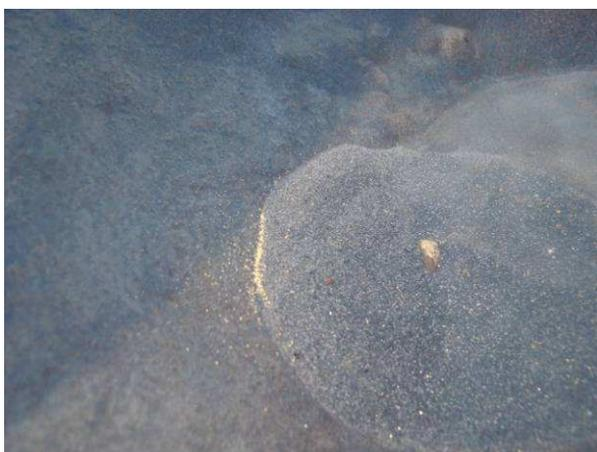
**Foto 7.3** – Pintas de ouro identificadas após o processo de bateamento.
