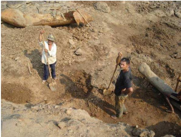
**Foto 8.1:** Local de extração do material mineralizado. Neste local, o material que contém ouro é caracterizado por granulação predominantemente arenosa e presença relevante de seixo e cascalho.
