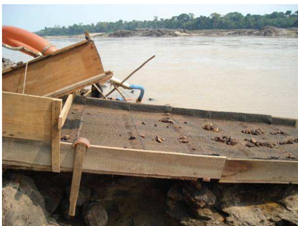
**Foto 2.3** – Caixa encarpada utilizada para lavagem do material mineralizado.
