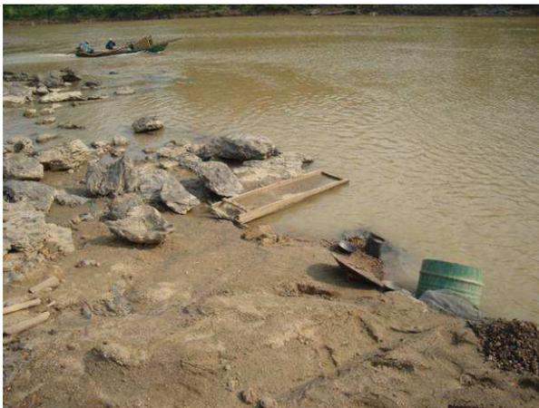
**Foto 8.3** - Caixa encarpada utilizada na lavagem do material mineralizado.
