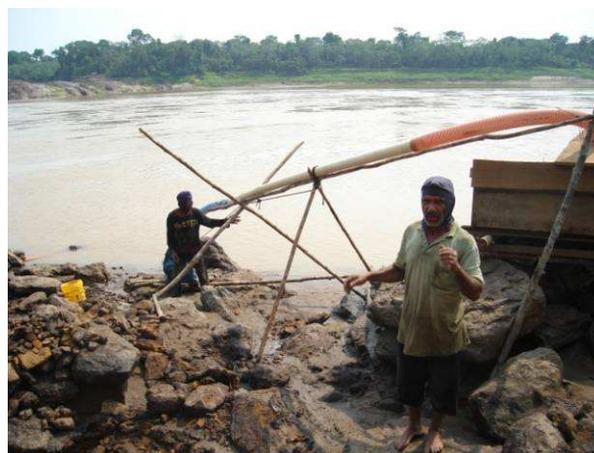
**Foto 2.2:** Mangueiras de bombeamento de água para lavagem do material na caixa encarpada.
