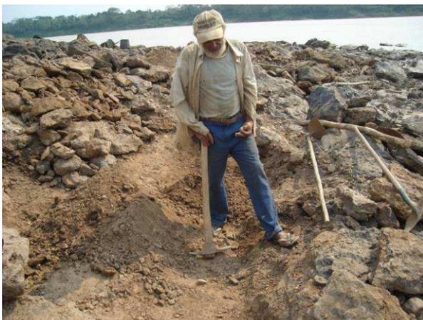
**Foto 7.1:** Local de extração do material mineralizado. Neste local, o material que contém ouro é caracterizado por granulação predominantemente arenosa e presença relevante de seixo e cascalho.
