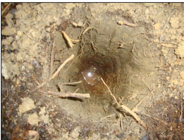
Foto 12 - Tradagem realizada onde se observa afloramento D'água 60cm. (Topo).
