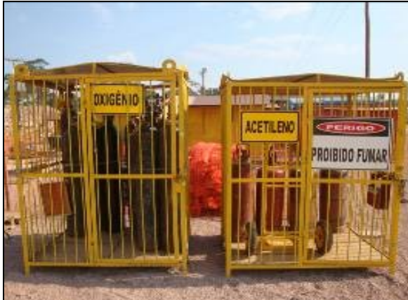
Foto 23: Armazenamento de gases
