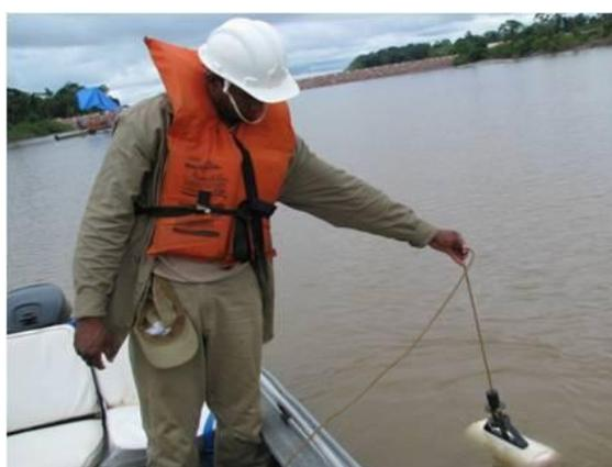
**Figura 21.** Coleta de água de fundo com garrafa de Van Dorn para o monitoramento das variáveis limnológicas.
