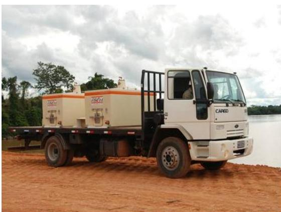
Figura 28. Caixa de transporte de peixes colocada sobre o caminhão.
