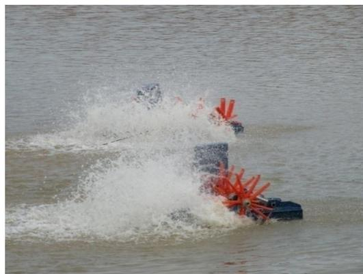
**Figura 3.** Detalhe de aeradores de pás (modelo Aquapás) em funcionamento.
