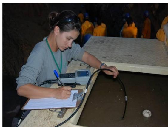
**Figura 20.** Monitoramento das variáveis limnológicas no interior da caixa de transporte de peixes.
