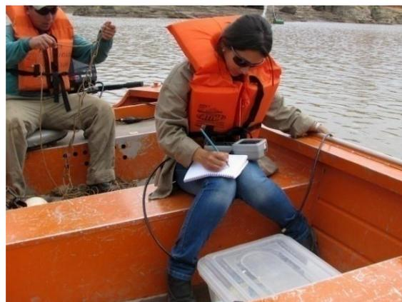
**Figura 18.** Monitoramento das variáveis limnológicas com sonda multiparamétrica no período diurno.
