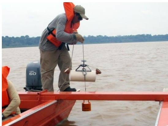
Figura 81. Utilização de garrafa tipo Van Dorn para coleta de água em diferentes profundidades.
