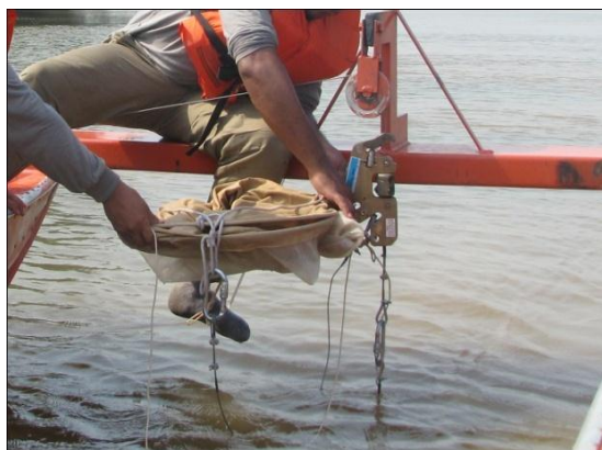
Figura 77. Detalhe do acoplamento da rede de ictioplâncton ao mecanismo de duplo estágio.
