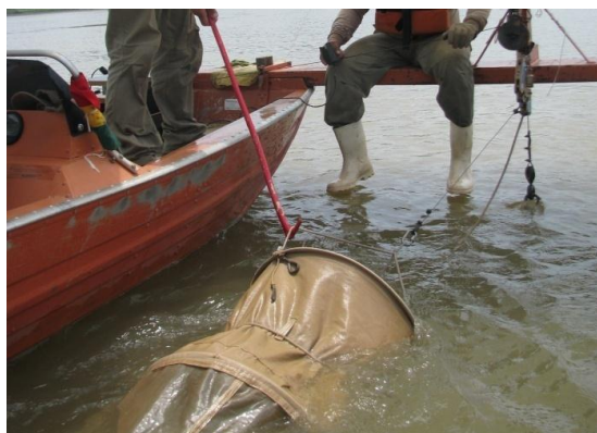
Figura 75. Utilização de rede ictioplâncton, com formato cônico-cilíndrico, para coleta de ovos e larvas.
