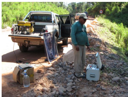
Figura 11. Equipamento de pesca elétrica sendo utilizado pela equipe do PCI do AHE Jirau.
