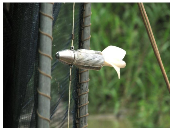
Figura 78. Detalhe do posicionamento do fluxímetro mecânico no centro da rede de coleta de juvenis.
