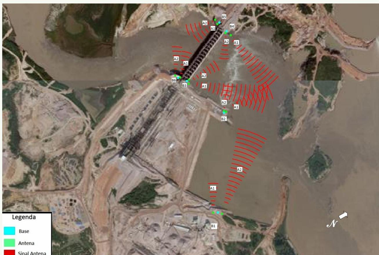
Figura 1. Área de cobertura estimada das estações fixas de radiotelemetria da UHE Jirau.
