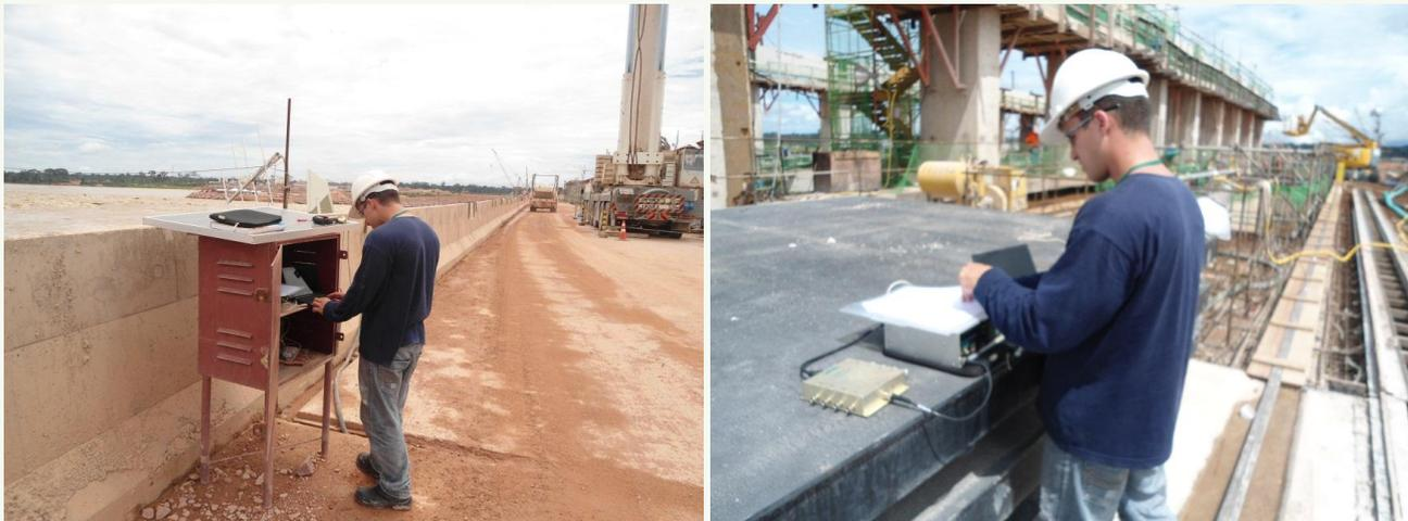
Figura 3. Downloading dos dados nas bases de monitoramento fixas.
