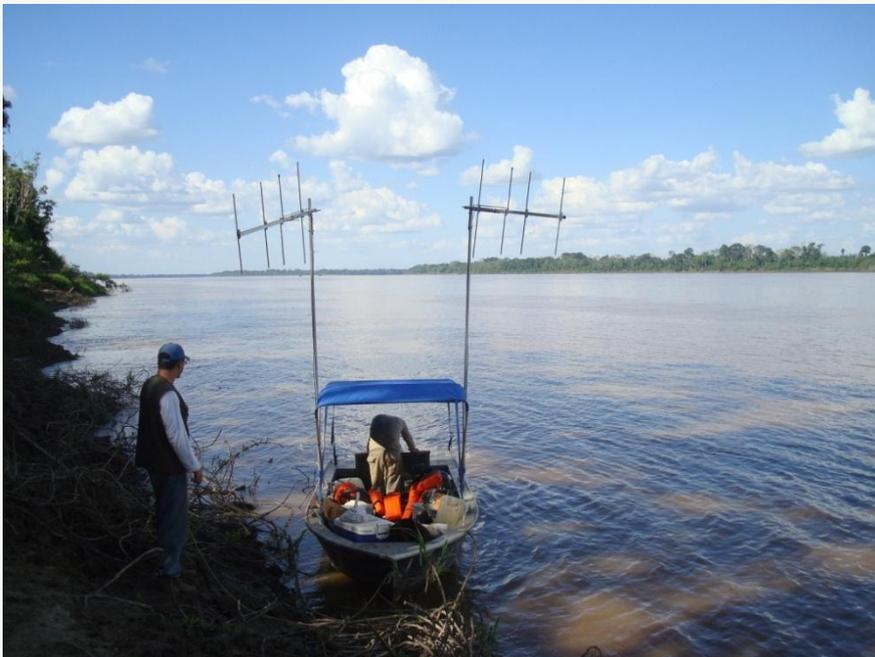
**Figura 2.** Antenas aéreas em barco para rastreamento de peixes por radiotelemetria.
