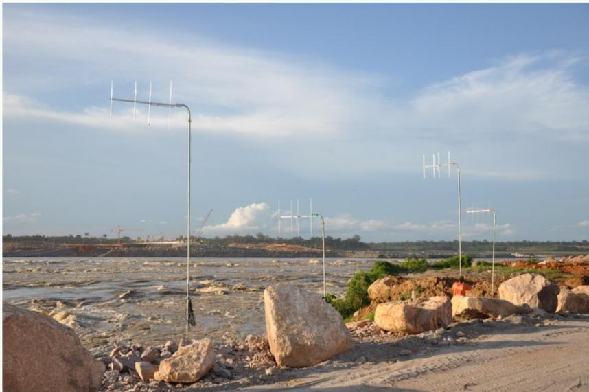
Figura 10. Antenas aéreas de radiotelemetria junto a UHE Santo Antônio.
