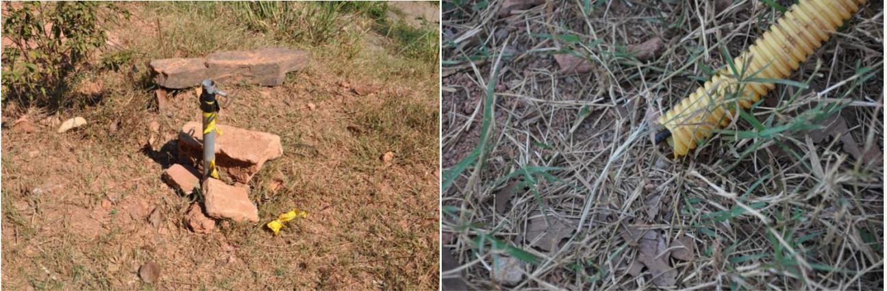
**Figura 2.** Hastes e cabos danificados por furto de antenas na base de Teotônio.
