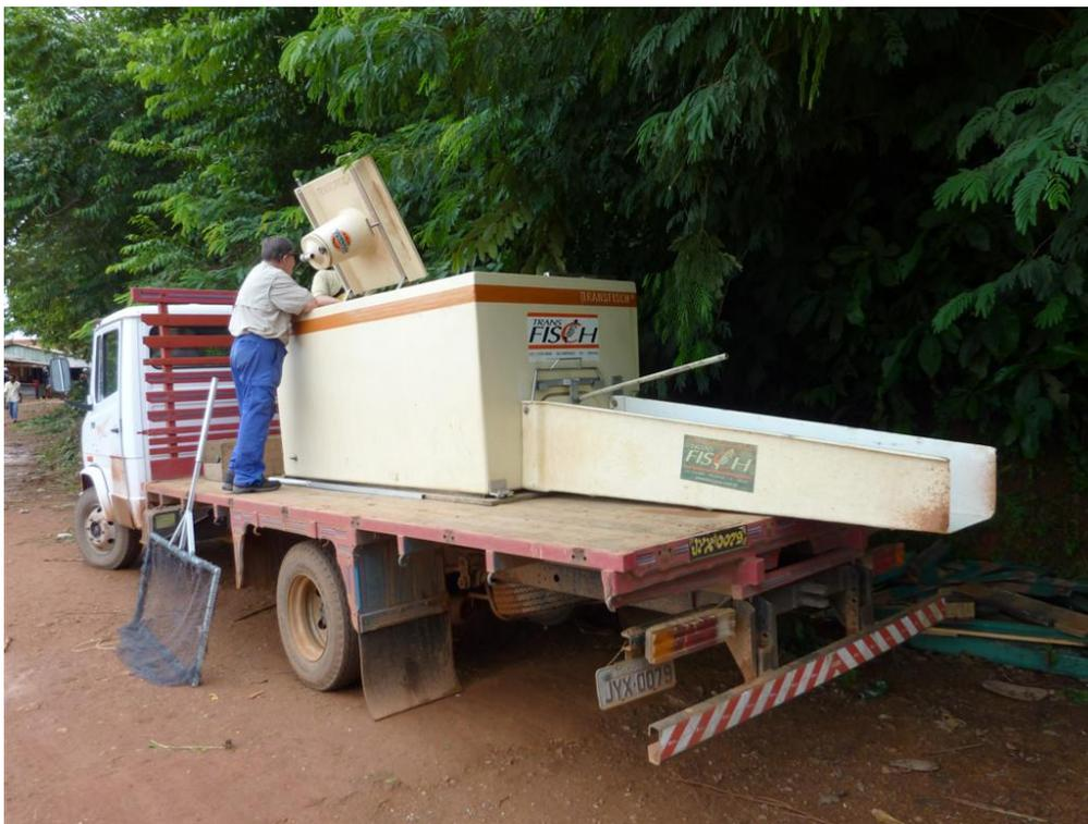
**Figura 6:** Caminhão com a caixa de transporte de peixes de 2.600 L, utilizada para transporte dos exemplares capturados próximos à cachoeira de Santo Antônio. Foto: Donald Pugh.
