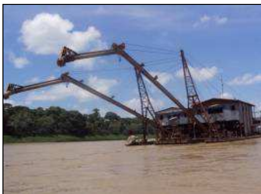
Foto 42: Embarcações de grande porte, as “dragas”, para extração de ouro. Fonte: CNEC, 2010
