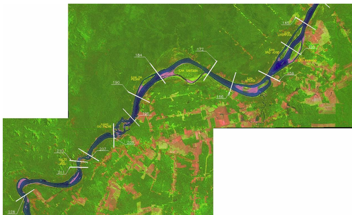
Figura 6.41 Trecho do Rio Madeira sujeito ao Assoreamento, de Acordo com a Modelagem
