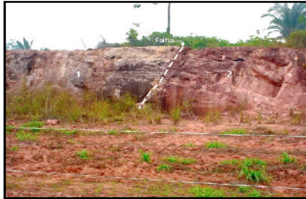
FOTO B.IV. 6 – Afloramento mostrando contato de granito pórfiro intrusivo (1) em metaturfo da Formação Mutum-Paraná. (2) Interface granito-metatufos e marcada por falha
