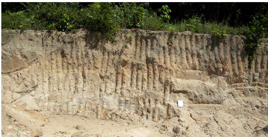
Figura 20 – (UTM 362173/8983206). Perfil de solo de aproximadamente 2,5m. Material proveniente dos sedimentos da formação Jaci-Praná. Neossolo Quartzarênico.
