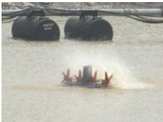
Foto 4.18.4 - Aerador de superfície em funcionamento no Recinto 4.
