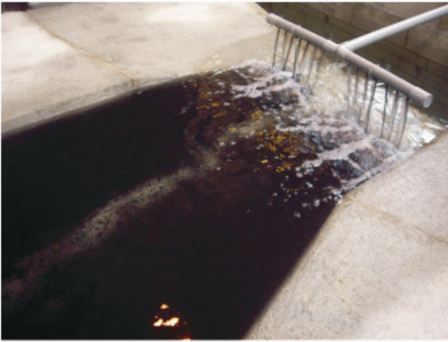
DETALHE DA INJEÇÃO DE SEDIMENTOS A MONTANTE
