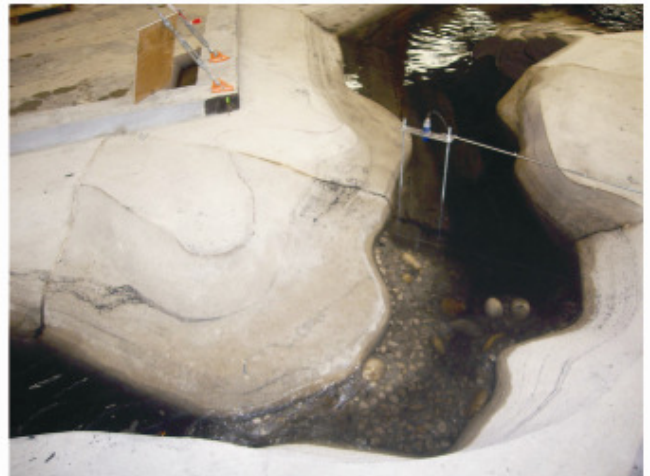
CORREDEIRAS DE JIRAU E MEDIÇÃO DO NÍVEL D'ÁGUA
