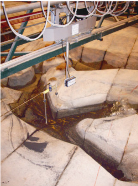
DETALHE DO SISTEMA DE LEVANTAMENTO DE SEDIMENTAÇÃO
