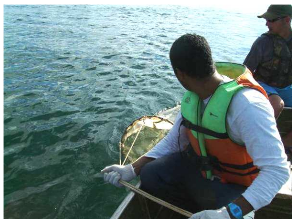
Figuras 18 a 21 - Coleta de Ictioplâncton com auxílio de rede com fluxômetro acoplado.
