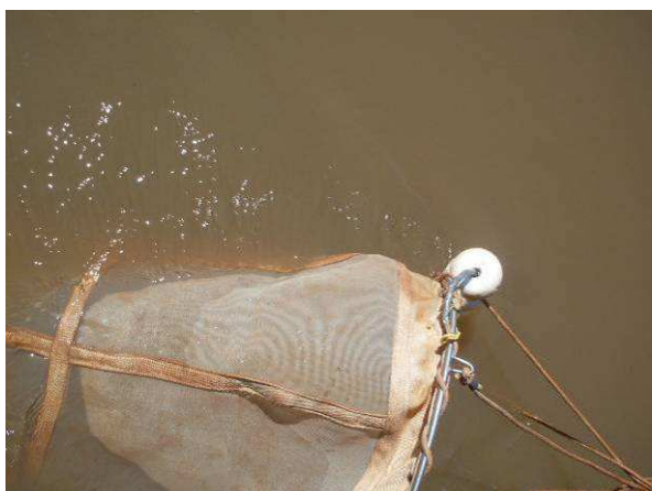
Figuras 33 a 34. Coleta de Ictioplâncton em diferentes pontos de amostragem com auxílio de rede com fluxometro acoplado.
