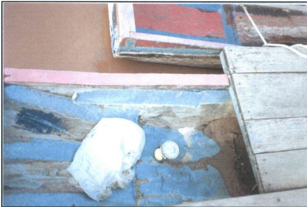
Foto 3 – Detalhe de uma das canoas que compõem a balsa. Verificação de remendos em chapa de zinco.
