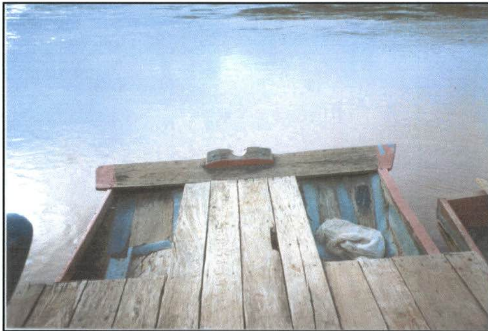
Foto 4 – Vista da proa da balsa e da base de apoio dos remos. Avista-se nas extremidades as duas balsas que apóia o assoalho.
