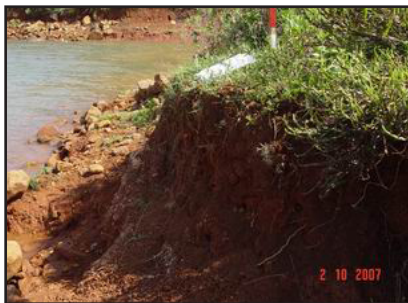
Figura 3.2 - Local F-2. Local de colocação da estaca, que recuou 8 cm desde sua colocação em Março de 2007. Fotografia: Outubro de 2007.
