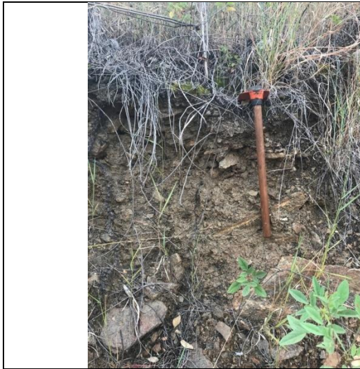
Figura 32: Perfil de Neossolo Litólico Tb distrófico A moderado, fase pedregosa, textura argilo-arenosa, montanhoso (UTM: 796794 / 7596398). Data: 26/01/2019.
