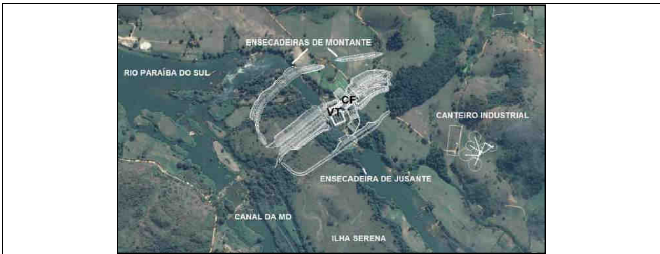
Figura 66: Desvio do Rio de 1ª fase – Estruturas Construídas. Fonte: Ecology Brasil, 2017.
