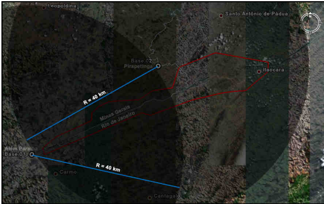
Figura 3 – Raio de Cobertura das Bases GPS
