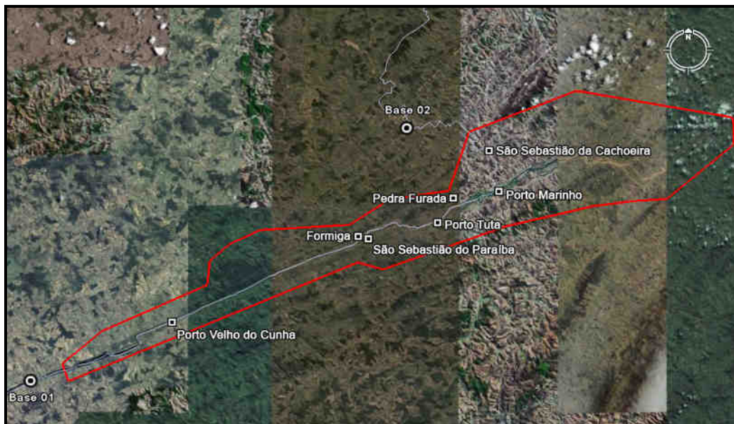
Figura 9 – Distribuição dos pontos de apoio aerofotogramétricos na área de interesse.
