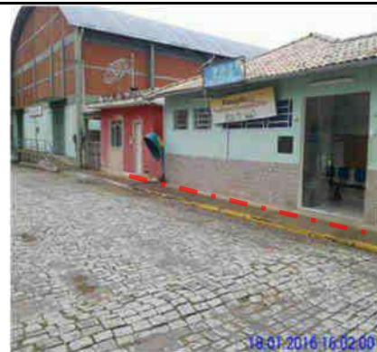
Figura 37: Marca de cheia na comunidade de São Sebastião do Paraíba em 2016. Fonte: UHE Itaipava S.A., 2016.
