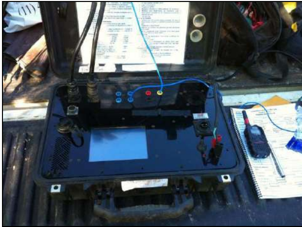
Fotos 30 e 31 - Resistivímetro ABM AL-48 c
