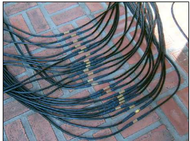
Fotos 32 e 33 - Cabos multipolares a passo 10 m
