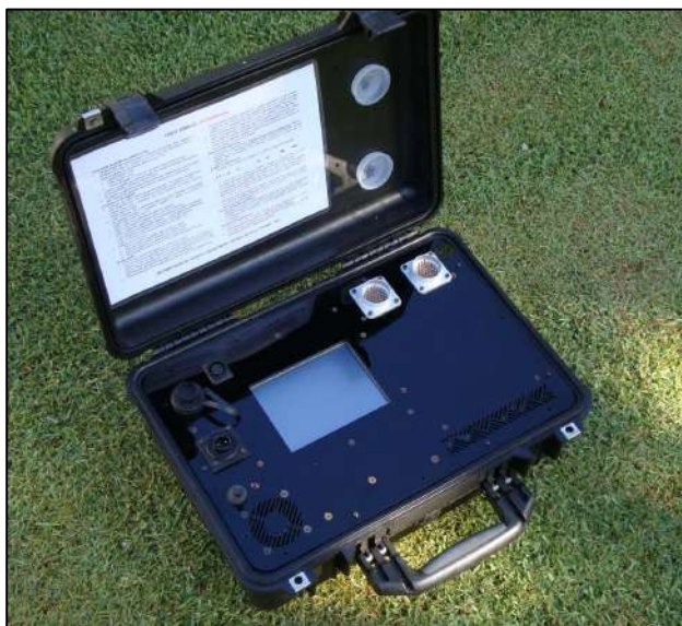
Foto 26 - Sismógrafo ABM BR-24
