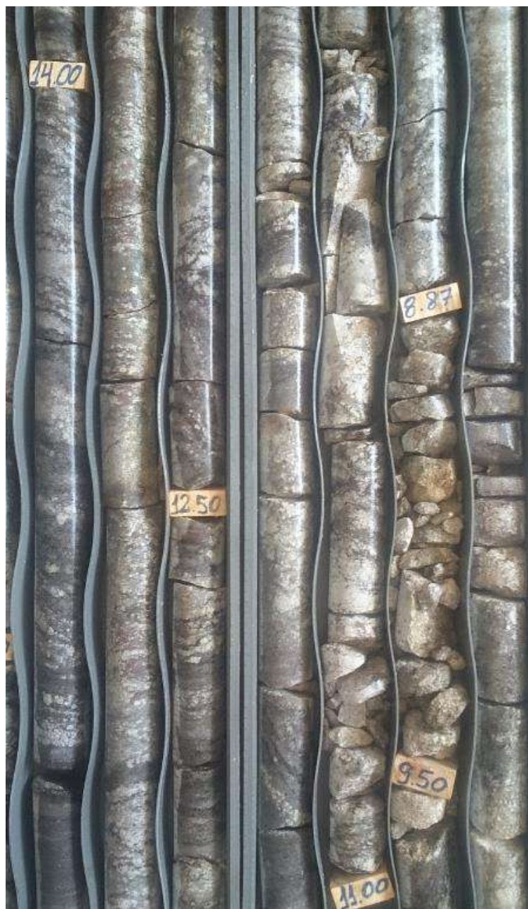
Figura 4.56 - SR-113 – Passagens de Maior Grau de Fraturamento e Alteração.
