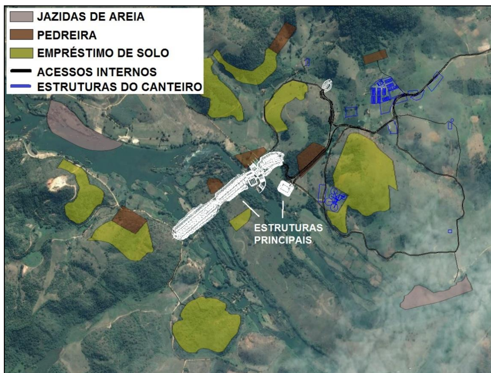
Figura 3-2- Estruturas do Canteiro de Obras
