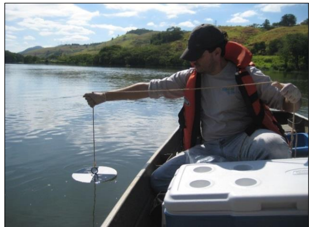
Figura 31: Medição da transparência da água com uso do Disco de Secchi, durante a execução do Programa.
