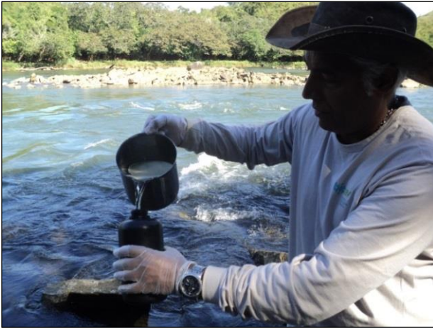
Figura 32: Procedimento de coleta de águas superficiais para análise em laboratório, durante a execução do Programa.
