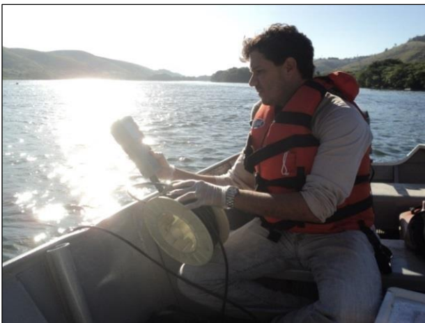
Figura 30: Medição de parâmetros físicos e químicos in situ com uso de sonda multiparâmetros, durante a execução do Programa.
