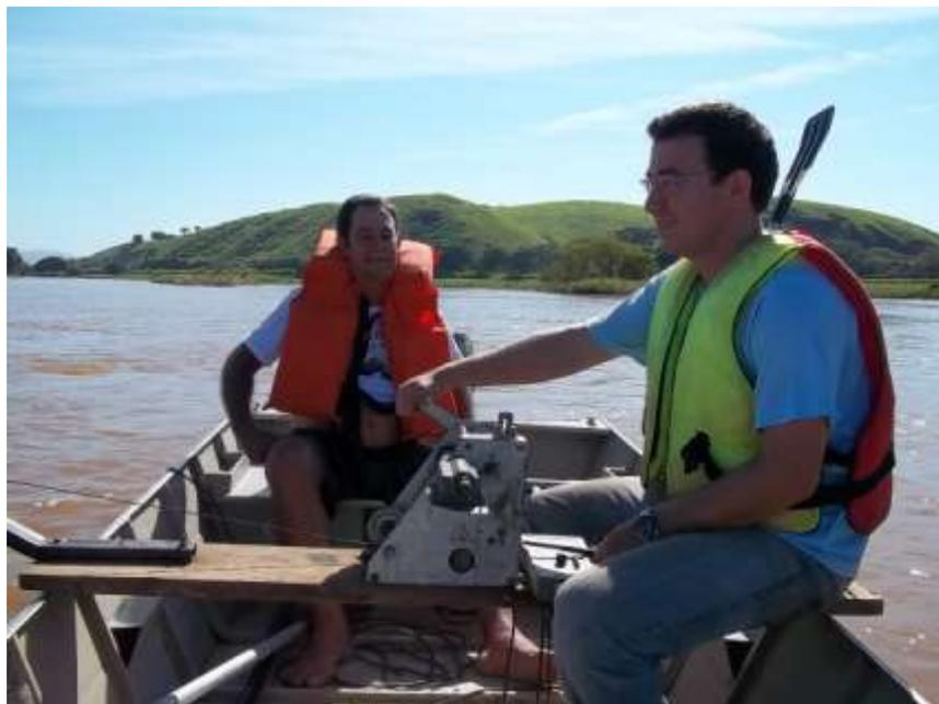
Foto 25 – Medição de descarga líquida na estação fluviométrica de Roda D'água no rio Paraíba do Sul em 08/02/2012.
