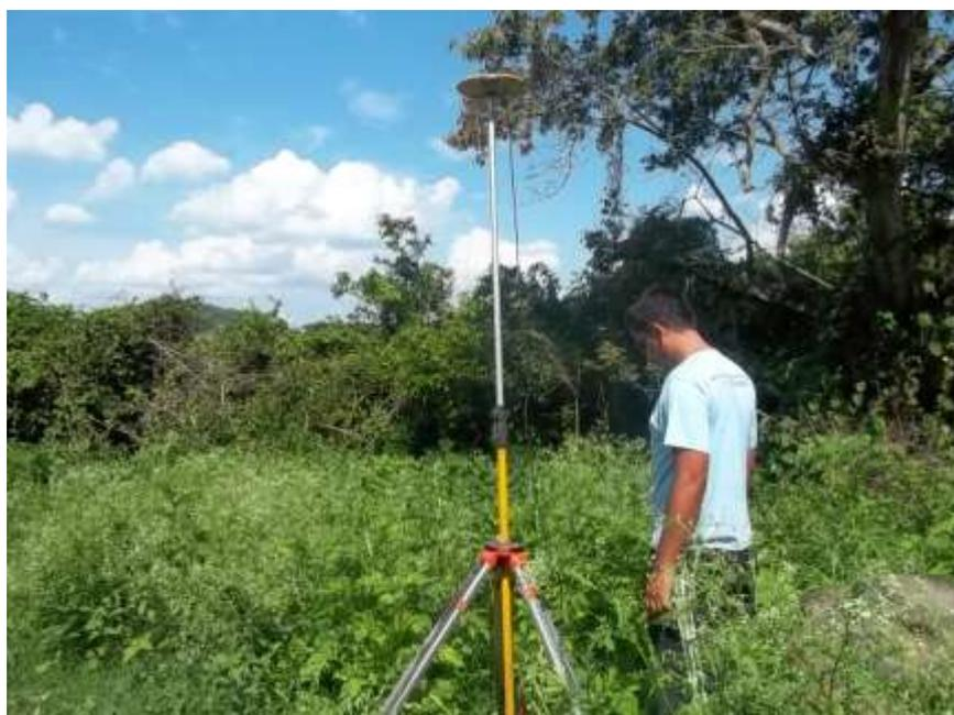
Foto 07 – Rastreamento com GPS da RN1 Itaocara I Montante para a RN1 da estação Itaocara I Canal de Fuga ME.
