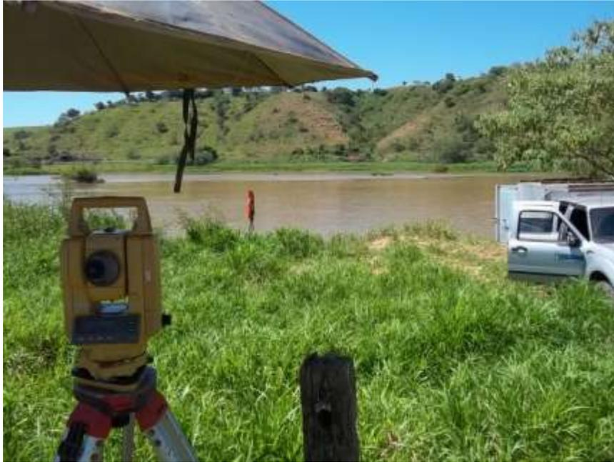
Foto 26 - Estação total na medição de descarga líquida na estação fluviométrica de Roda D'água no rio Paraíba do Sul em 01/03/2012.
