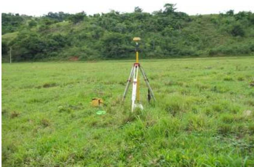
Foto 08 – Rastreamento com GPS da RN1 Itaocara I Montante para a RN1 da estação Itaocara II Formiga Montante - 800 m ME.
