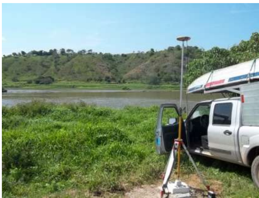
Foto 04 – Rastreamento com GPS da RN1 Itaocara Montante para a RN-1 da estação Itaocara Roda D'água.
