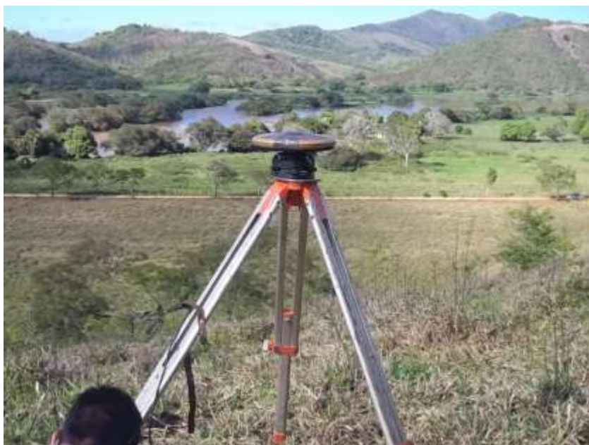
Foto 03 – Rastreamento com GPS do Marco M2 para RN1 da estação Itaocara Montante no rio Paraíba do Sul.
