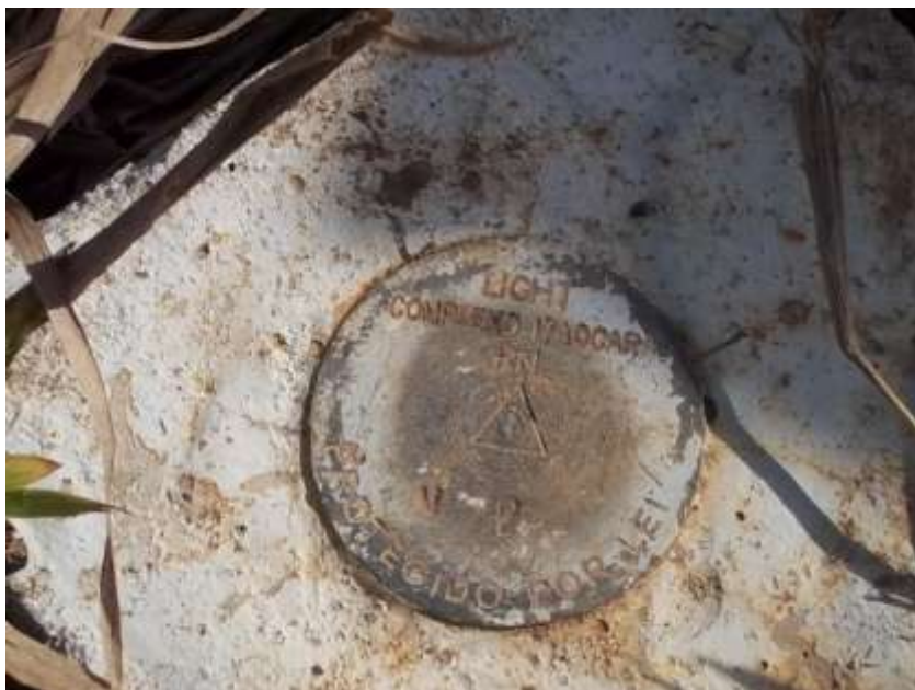
Foto 02 – Marco M2 localizado no morro das cruzeiras, ombreira esquerda do barramento da UHE Itaocara no rio Paraíba do Sul.
