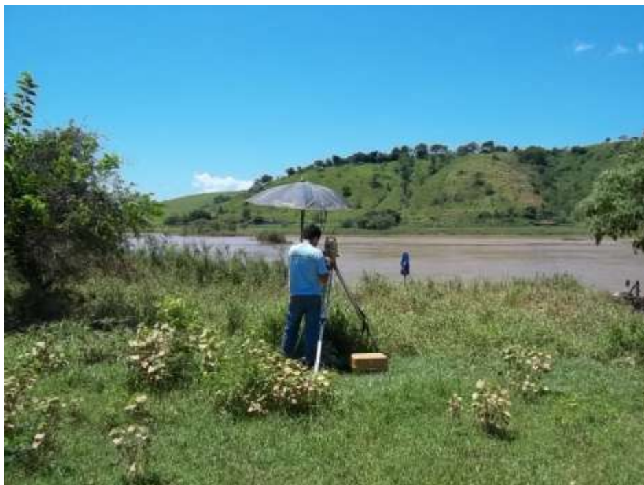
Foto 04 - Estação total posicionada na medição de descarga líquida na estação fluviométrica de Roda D'água no rio Paraíba do Sul em 08/02/2012.
