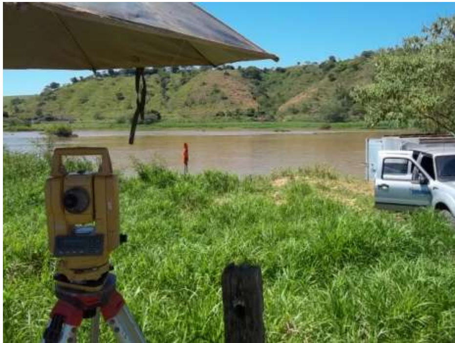
Foto 07 - Estação total posicionada na medição de descarga líquida na estação fluviométrica de Roda D'água no rio Paraíba do Sul em 01/03/2012.
