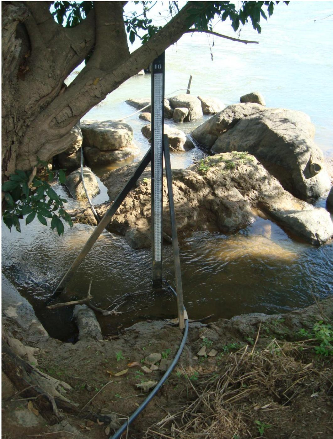
**Foto 02** - Vista da reinstalação das régua da estação fluviométrica de Itaocara na margem esquerda do rio Paraíba do Sul.
