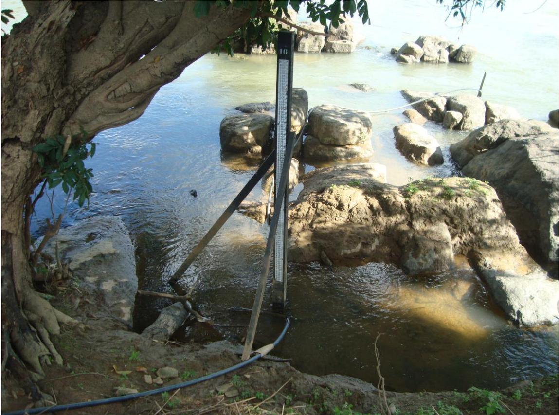
**Foto 03** – Outro detalhe das régua na estação fluviométrica de Itacara nos fundos da casa do Sr. José Luiz na margem esquerda do rio Paraíba do Sul.
