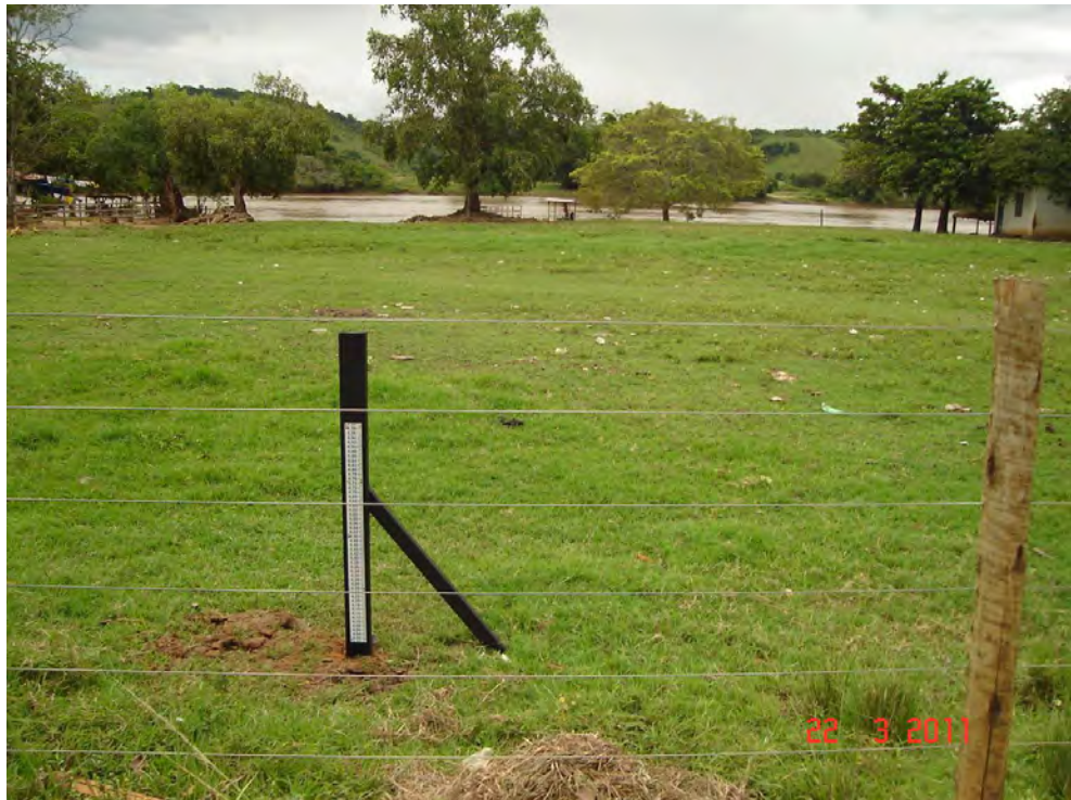
Foto 15 - Detalhe do último lance de réguas da estação fluvio-sedimentométrica de Porto do Tuta, instalado próximo a estrada
