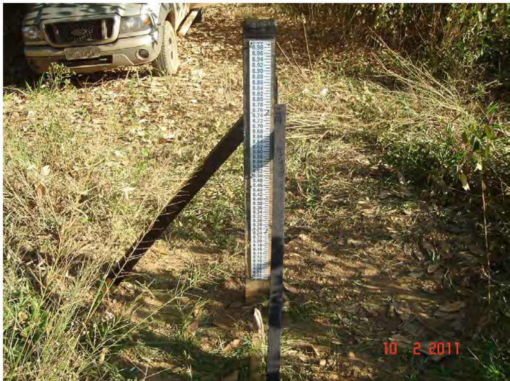
Foto 10 - Detalhe do lance de réguas 18,00 a 19,00 instalado na estação fluviométrica de Itaocara II Formiga Montante
