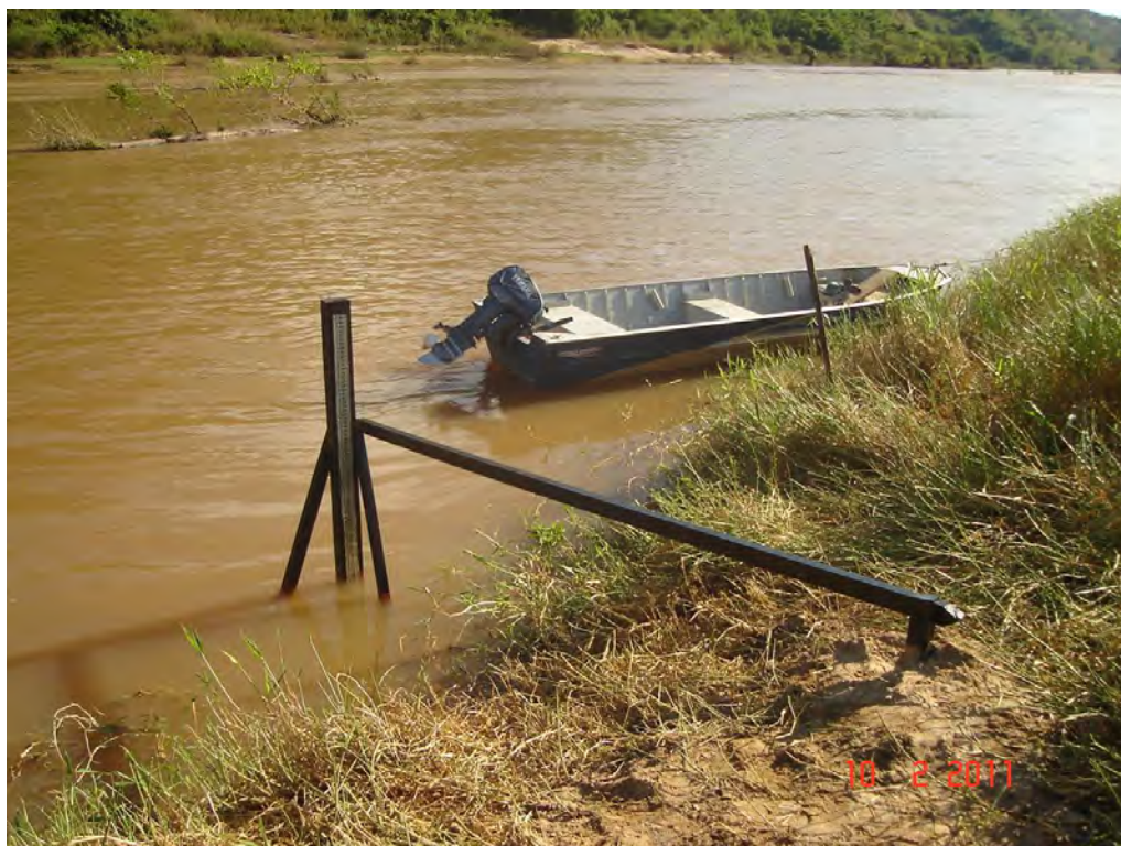
Foto 08 – Detalhe do lance de réguas 16,00 a 18,00, instalado na estação fluviométrica de Itaocara II Formiga Montante
