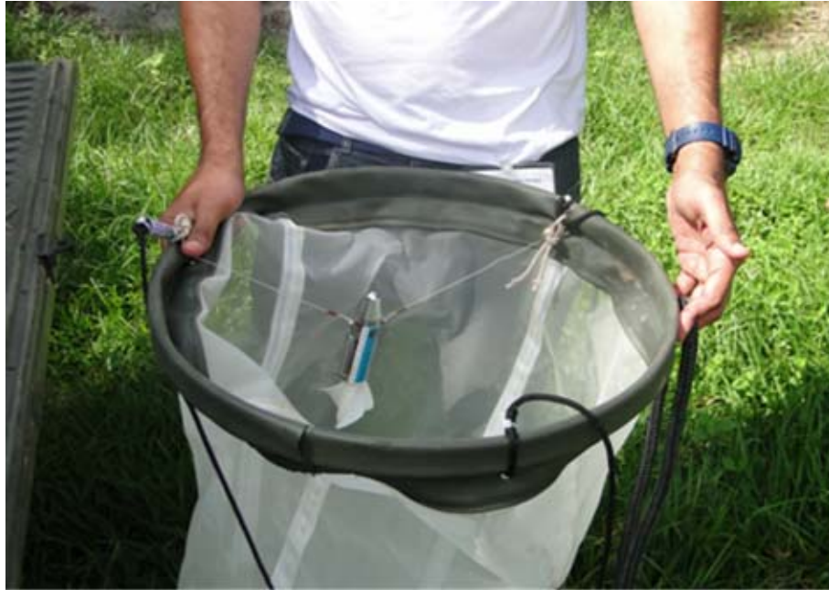
Figura 14. Detalhe do fluxômetro na rede de plancton utilizada nas amostragens (Ic 9). Data: 21/12/2012. Hora: 8:49.
