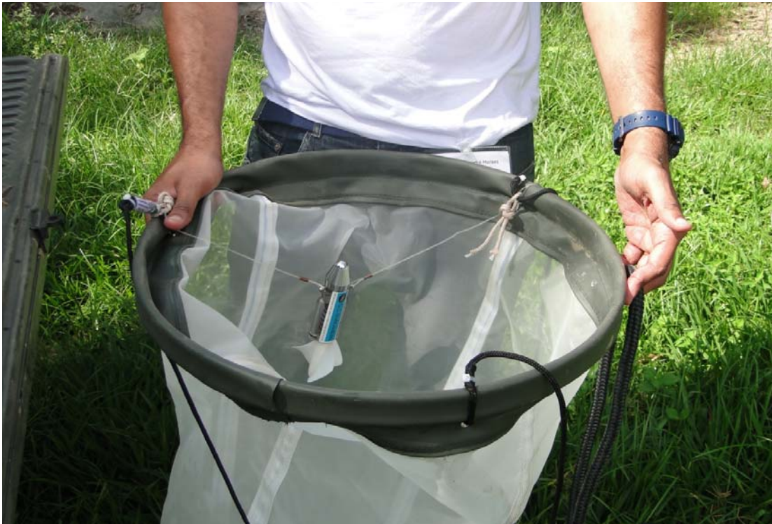
Figura 12. Uso do fluxômetro durante as amostragens (Ic9). Data: 21/12/2012. Hora: 8:49.
