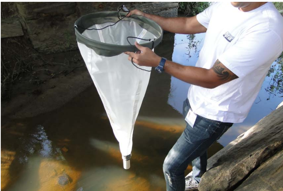
Figura 13. Uso da rede de plâncton cônico-cilíndrica durante as amostragens (Ic9). Data: 21/12/2012. Hora: 7:02.
