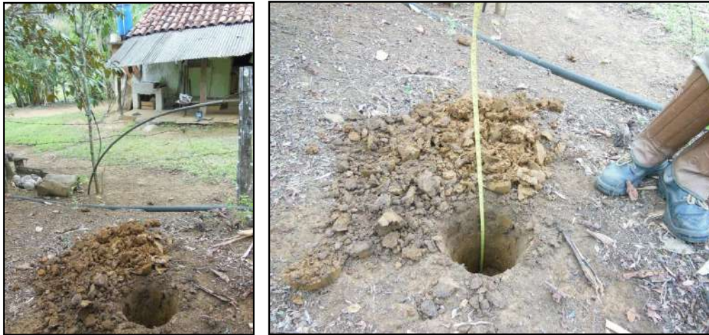
Figura 3.4.1.3.15.11 – Tradagem com profundidade de 45 cm. Área de depósito de lixo atual. Coordenadas UTM 790950 E, 7602792 N.
