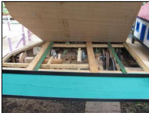
Figura 3.4.2.3.7.3 – Sistema de movimentação das peças da maquete. Coordenadas UTM 794360 E, 7601569 N.
