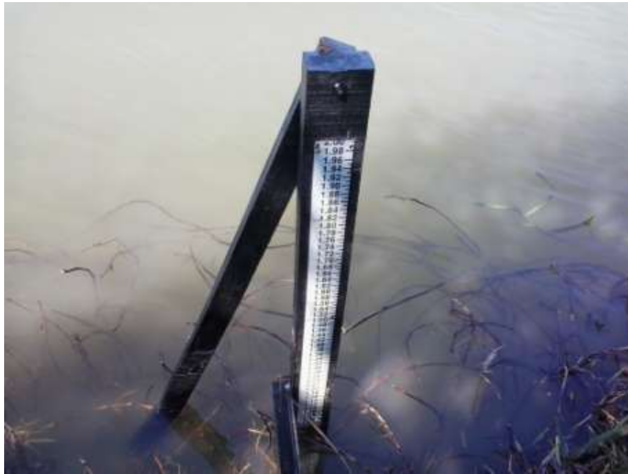
Figura 2 -Manutenção do primeiro lance de régua da estação fluviométrica de Itaocara I Roda D'água no rio Paraíba do Sul
