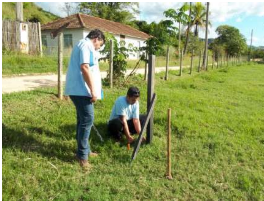
Foto 21 – Manutenção do lance 4/5 da estação Itaocara II Porto do Tuta no rio Paraíba do Sul.
