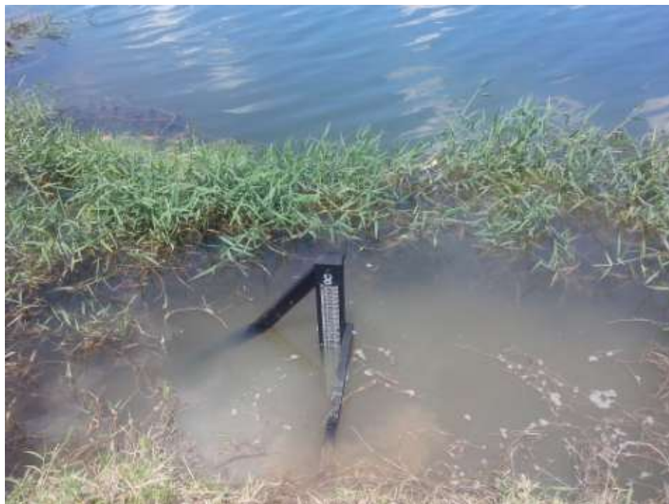
Vista do primeiro lance de réguas da estação de Itaocara II Canal Esquerdo
