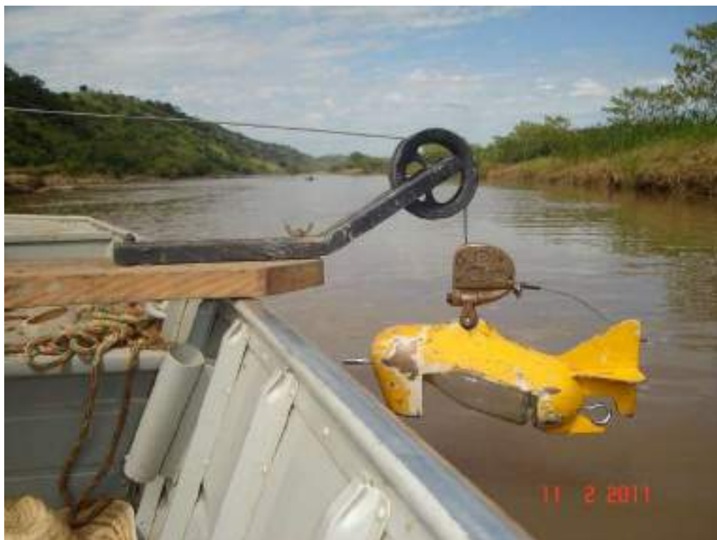
Foto 10 - Medição de descarga sólida na estação fluviométrica de Itaocara II Formiga Montante no rio Paraíba do Sul.
