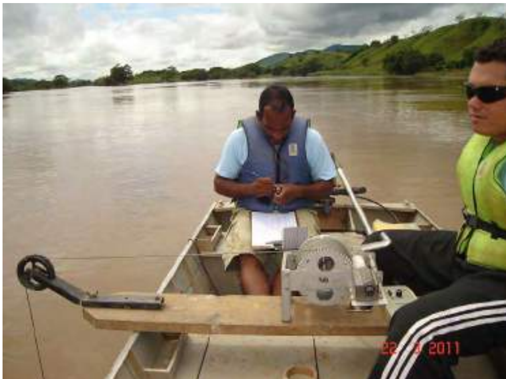
Foto 16 - Detalhe da medição de descarga líquida realizada em 22-03-2011 na estação fluvio-sedimentométrica de Porto do Tuta.
