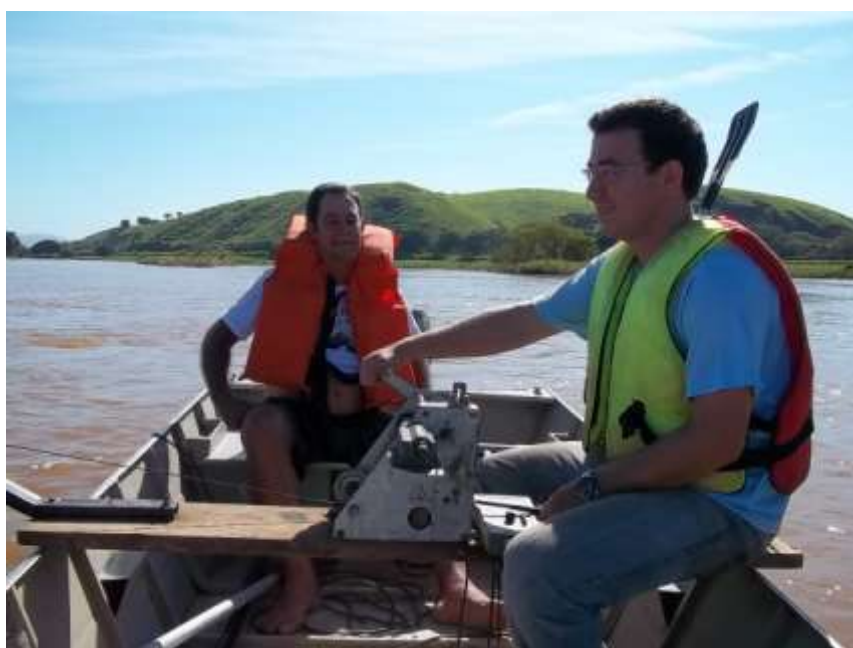
Foto 25 – Medição de descarga líquida na estação fluviométrica de Roda D'água no rio Paraíba do Sul em 08/02/2012.
