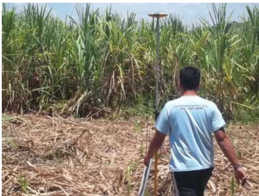
Foto 05 – Rastreamento com GPS da RN1 Itaocara | Montante Eixo para o piquete de apoio da estação Itaocara Roda D'água.
