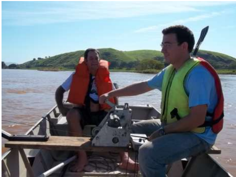
Foto 05 – Medição de descarga líquida na estação fluviométrica de Roda D'água no rio Paraíba do Sul em 08/02/2012.
