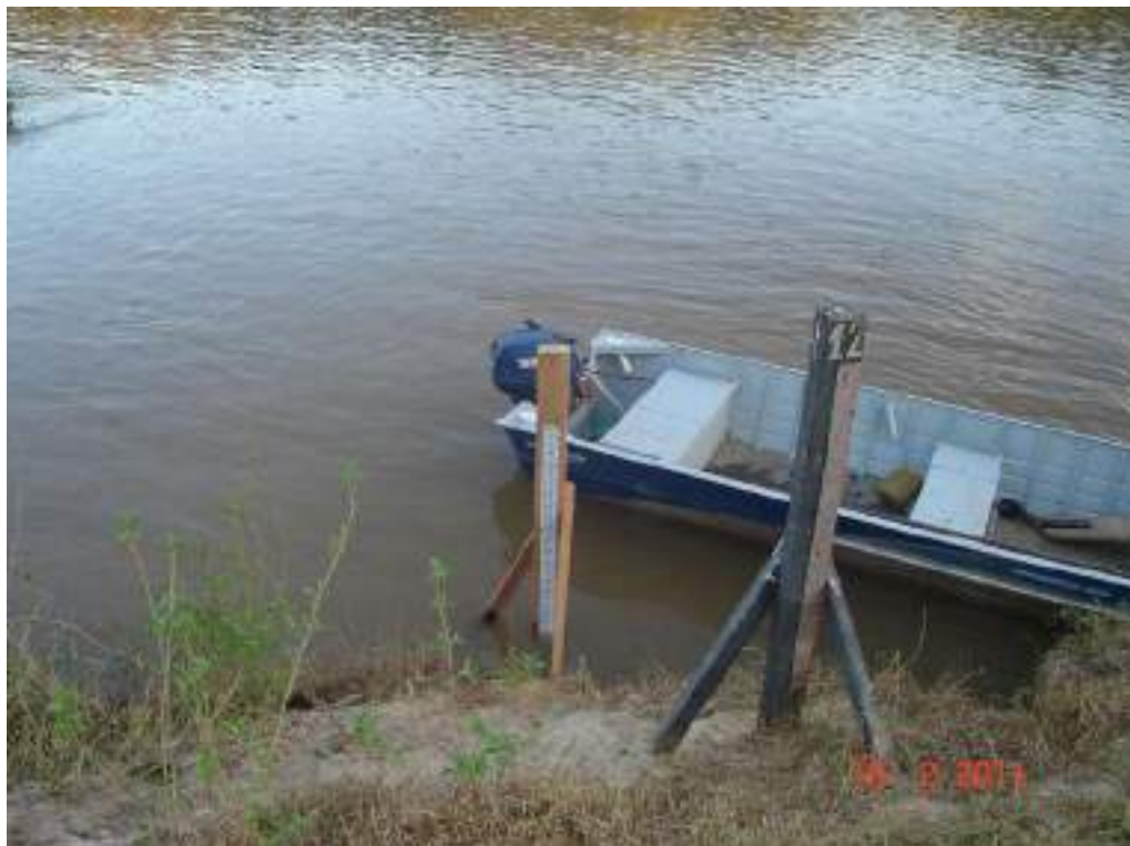
Foto 14 - Reinstalação do lance de réguas 09,00 a 11,00 da estação fluviométrica de Itaocara II Formiga Jusante.
