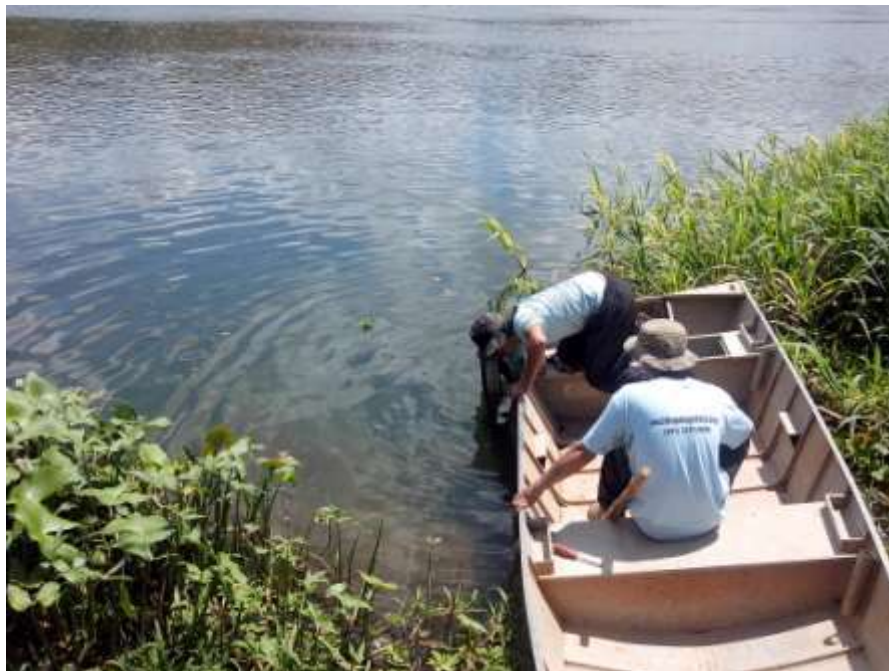
Figura 23 - Limpeza do primeiro lance de régua da estação limnimétrica de Itaocara São Sebastião do Paraíba Montante no rio Paraíba do Sul
