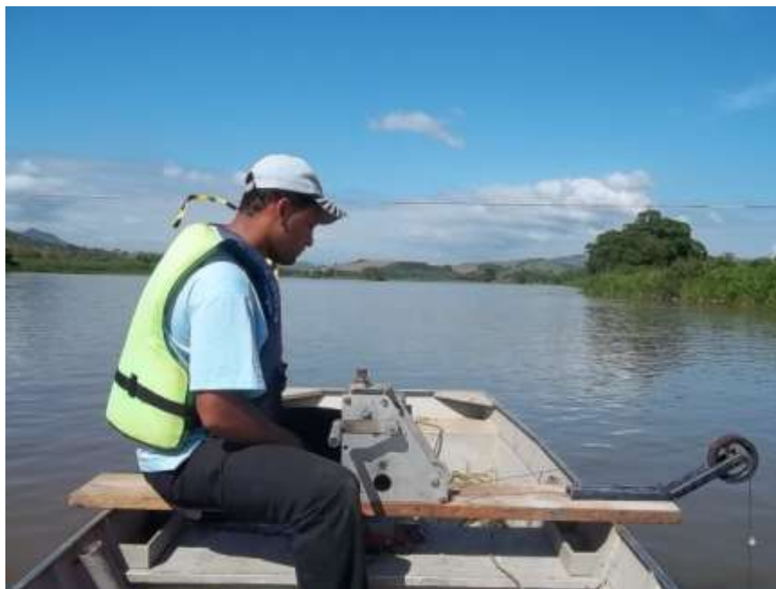
Foto 22 – Medição de descarga líquida na estação fluviométrica de Roda D'água no rio Paraíba do Sul em 05/11/2011.
