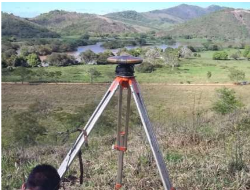
Foto 03 – Rastreamento com GPS do Marco M2 para RN1 da estação Itaocara I Montante no rio Paraíba do Sul.
