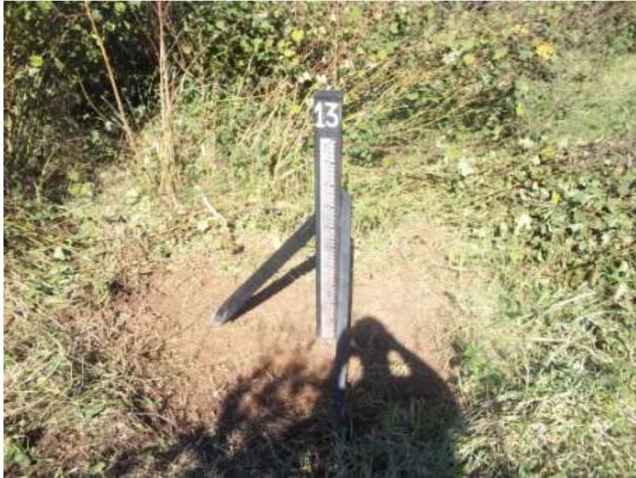
Figura 18 - Vista do lance de régua 12/13 após a manutenção da estação limnimétrica de Itaocara II Eixo ME do rio Paraíba do Sul
