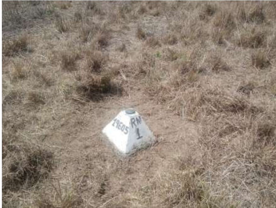
Figura 22 - Vista da RN1 após a manutenção na estação limnimétrica de Itaocara Formiga Montante do rio Paraíba do Sul
