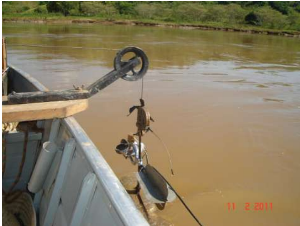
Foto 09- Medição de descarga líquida na estação fluviométrica de Itaocara II Formiga Montante no rio Paraíba do Sul.
