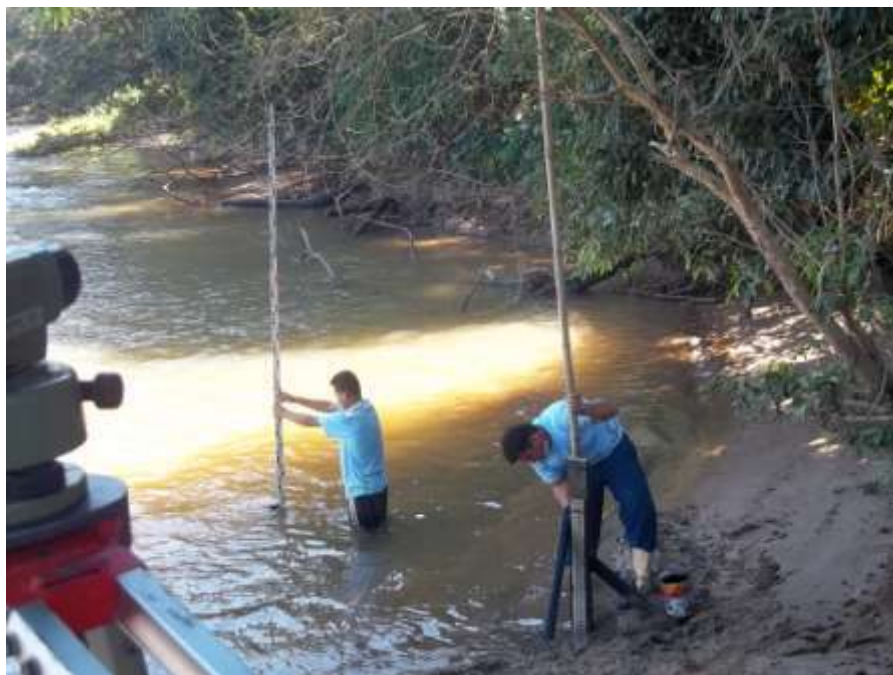
Figura 27 - Vista da manutenção do lance de régua 12/13 da estação limnimétrica de Itaocara I Eixo ME do rio Paraíba do Sul
