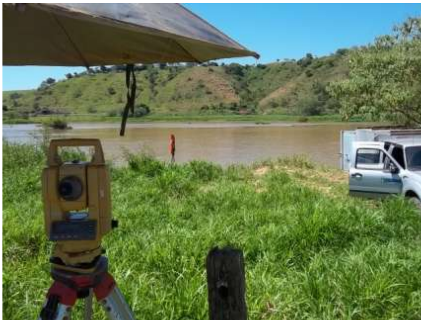
Foto 26 - Estação total na medição de descarga líquida na estação fluviométrica de Roda D'água no rio Paraíba do Sul em 01/03/2012.
