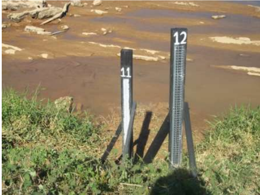
Figura 17 - Vista dos dois primeiros lances de régua da estação limnimétrica de Itaocara II Eixo ME do rio Paraíba do Sul
