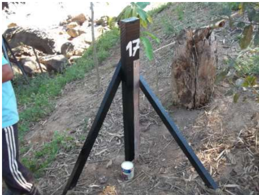
Figura 29 - Vista da manutenção do lance de régua 16/17 da estação limnimétrica de Itaocara I Eixo ME do rio Paraíba do Sul
