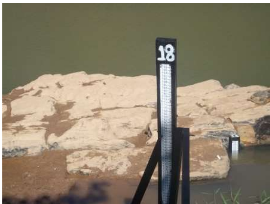
Figura 21 - Vista dos primeiros lances de régua 15/16 e 16/18 da estação limnimétrica de Itaocara II Formiga Montante do rio Paraíba do Sul
