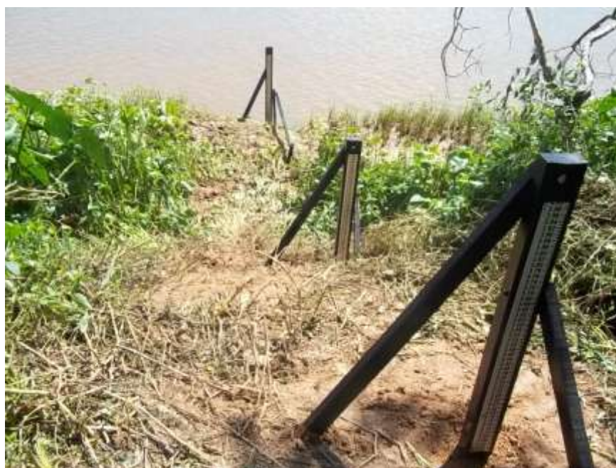
Foto 14 - Vista dos lances de régua no local de instalação da estação Itaocara I Canal de Fuga ME no rio Paraíba do Sul.
