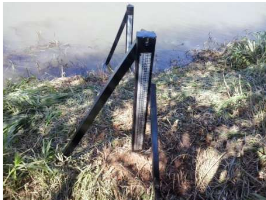
Figura 3 - Manutenção dos dois primeiros lances de régua da estação fluviométrica de Itaocara I Roda D'água no rio Paraíba do Sul
