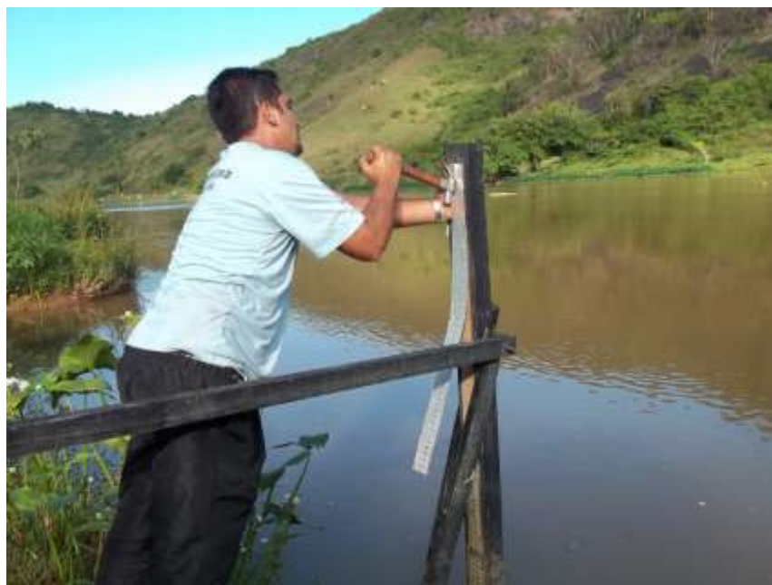
Foto 16 – Detalhe da substituição dos lances 16/18 da estação Itaacara II Formiga Montante 800 m ME no rio Paraíba do Sul.
