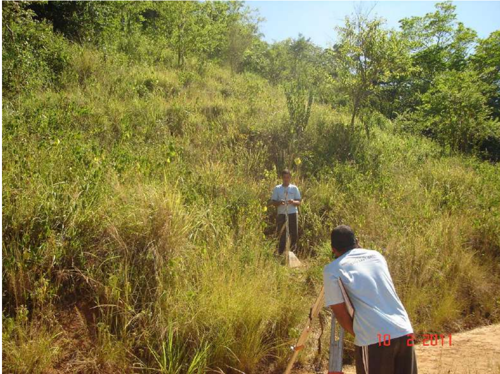
Foto 11 – Nivelamento para reinstalação das réguas destruídas pela enchente de janeiro na estação fluviométrica de Itaocara II no rio Paraíba do Sul.
