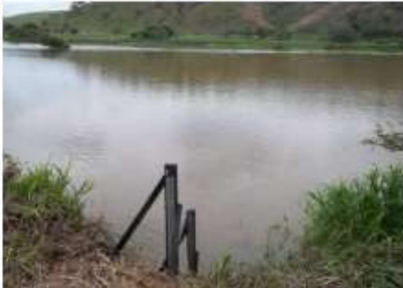
Lances de réguas e sessão de medição da estação fluviométrica Itaocara Roda D'água.
