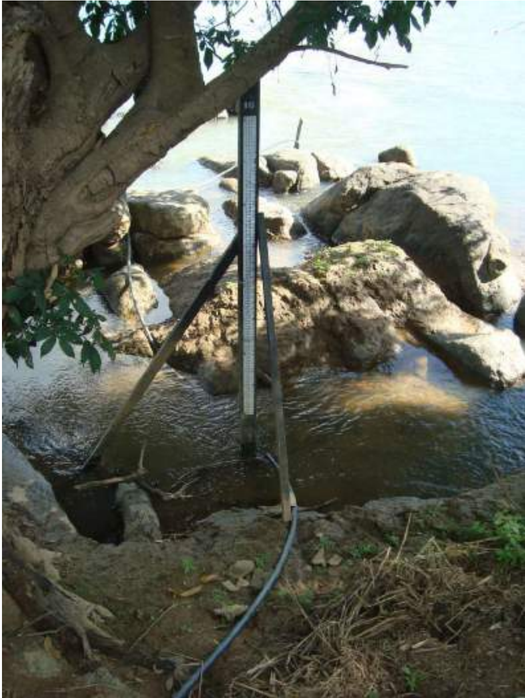
Foto 02 - Vista da reinstalação das réguas da estação fluviométrica de Itaocara na margem esquerda do rio Paraíba do Sul.
