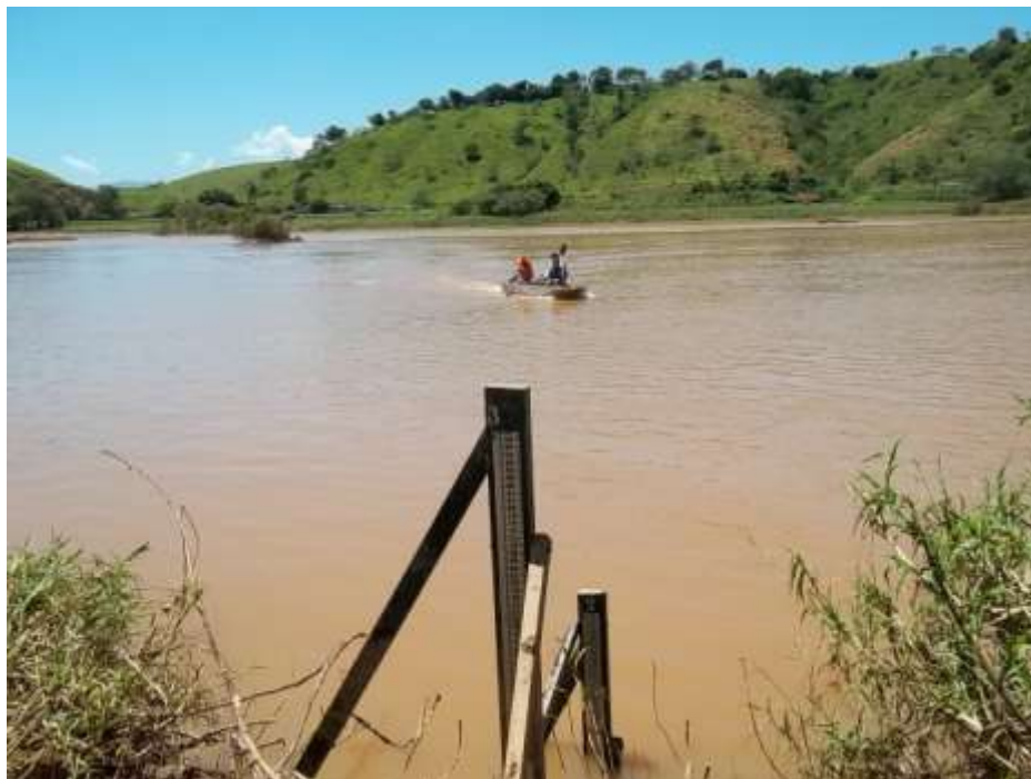
Foto 02 – Medição de descarga líquida na estação fluviométrica de Roda D'água no rio Paraíba do Sul em 07/02/2012.
