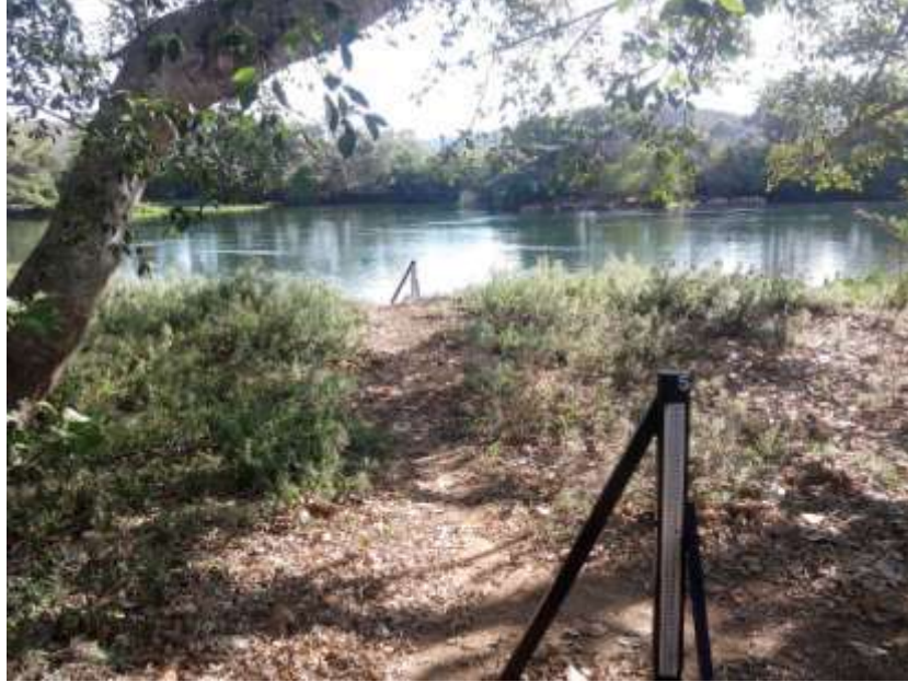
Vista dos lances de réguas da estação limnimétrica de Itaocara I Canal de Fuga ME no rio Paraíba do Sul.
