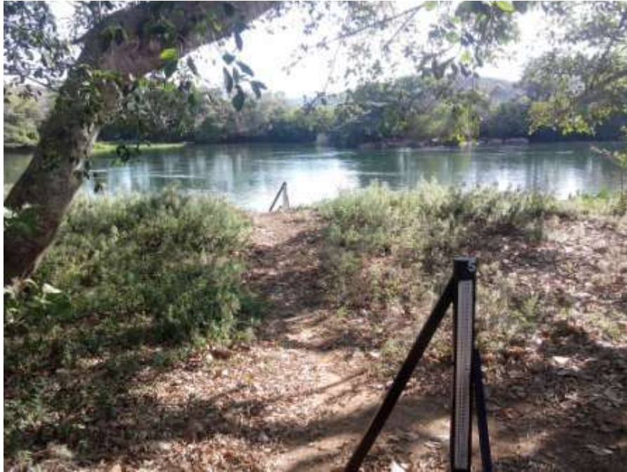
Figura 6 - Vista dos dois lances de réguas da estação limnimétrica de Itaocara I Canal de Fuga - ME no rio Paraíba do Sul
