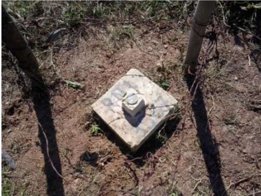
Figura 4 - Manutenção e limpeza da RN1 estação fluviométrica de Itacara – Roda D'Água no Rio Paraíba do Sul
