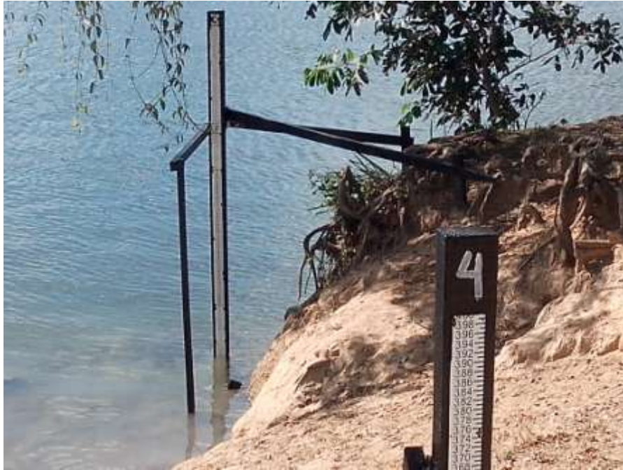
Figura 8 - Detalhe da manutenção dos primeiros lances de régua da estação fluviométrica de Itacara I Porto do Tuta no rio Paraíba do Sul
