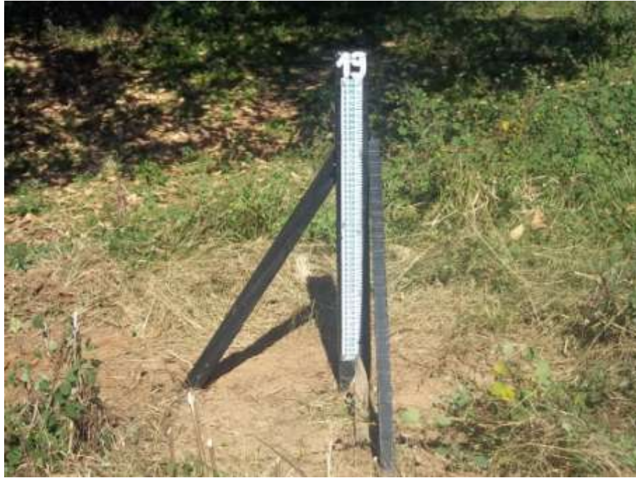
Figura 22 - Vista do lance de régua 19/20 após a manutenção da estação limnimétrica de Itaocara II Formiga Montante do rio Paraíba do Sul
