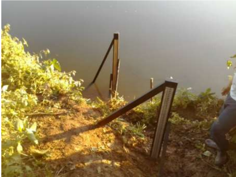
Figura 6 - Manutenção dos dois primeiros lances de régua da estação limnimétrica de Itaocara I Canal de Fuga - ME no rio Paraíba do Sul
