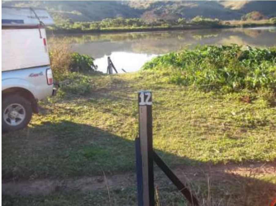
Figura 25 - Vista geral dos lances de régua 08/10, 10/11 e 11/12 da estação limnimétrica de Itaocara II Eixo MD do rio Paraíba do Sul
