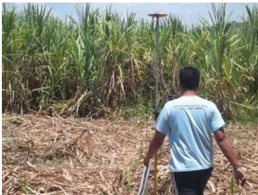
Foto 05 – Rastreamento com GPS da RN1 Itaocara Montante para o piquete de apoio da estação Itaocara Roda D'água.
