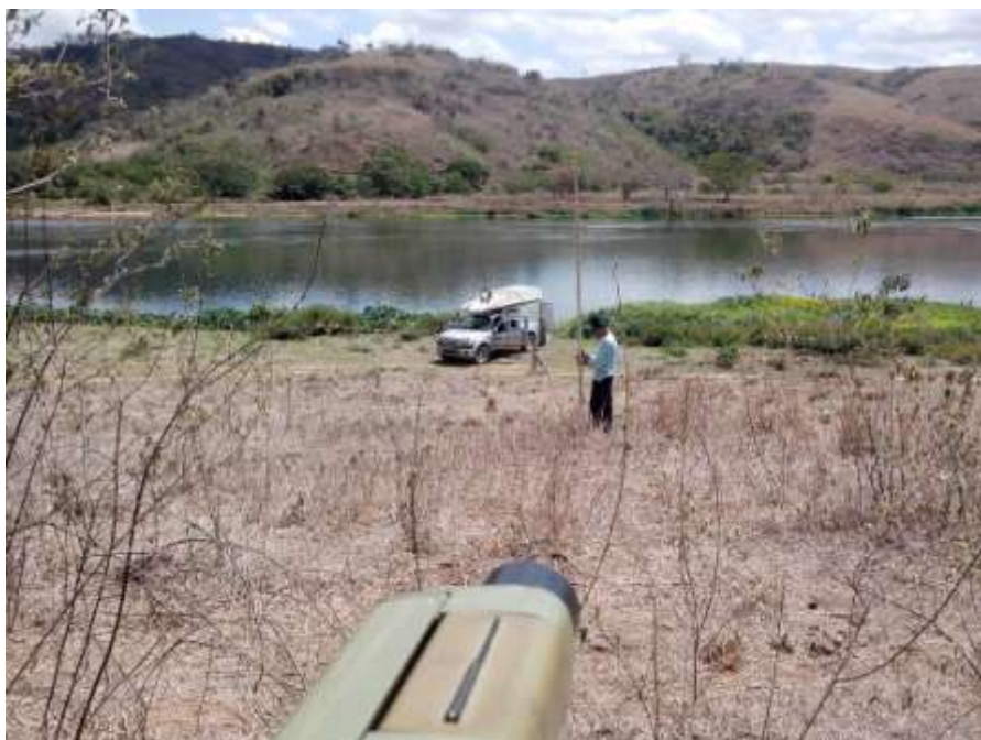
Figura 25 - Nivelamento dos lances de régua da estação limnimétrica de Itaocara I São Sebastião do Paraíba Montante no rio Paraíba do Sul
