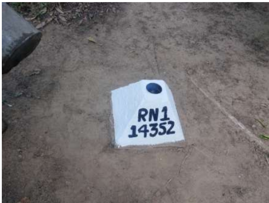
Figura 13 - Detalhe da manutenção da RN1 da estação limnimétrica de Itaocara São Sebastião do Paraíba no rio Paraíba do Sul
