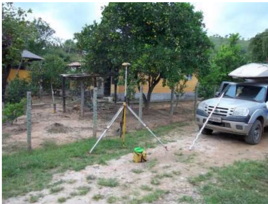
Foto 10 – Rastreamento com GPS da RN1 Itaocara I Montante para a RN2 da estação Itaocara II São Sebastião do Paraíba.
