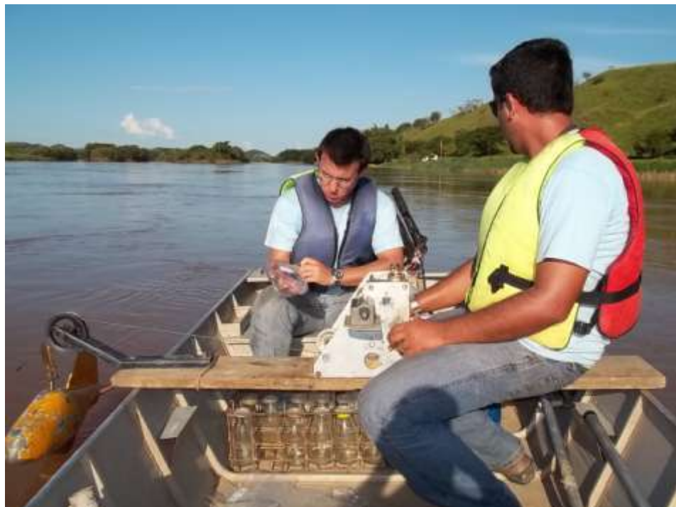
Foto 20 - Medição de descarga sólida realizada em 07-02-2012 na estação fluvio-sedimentométrica de Porto do Tuta no rio Paraíba do Sul.
