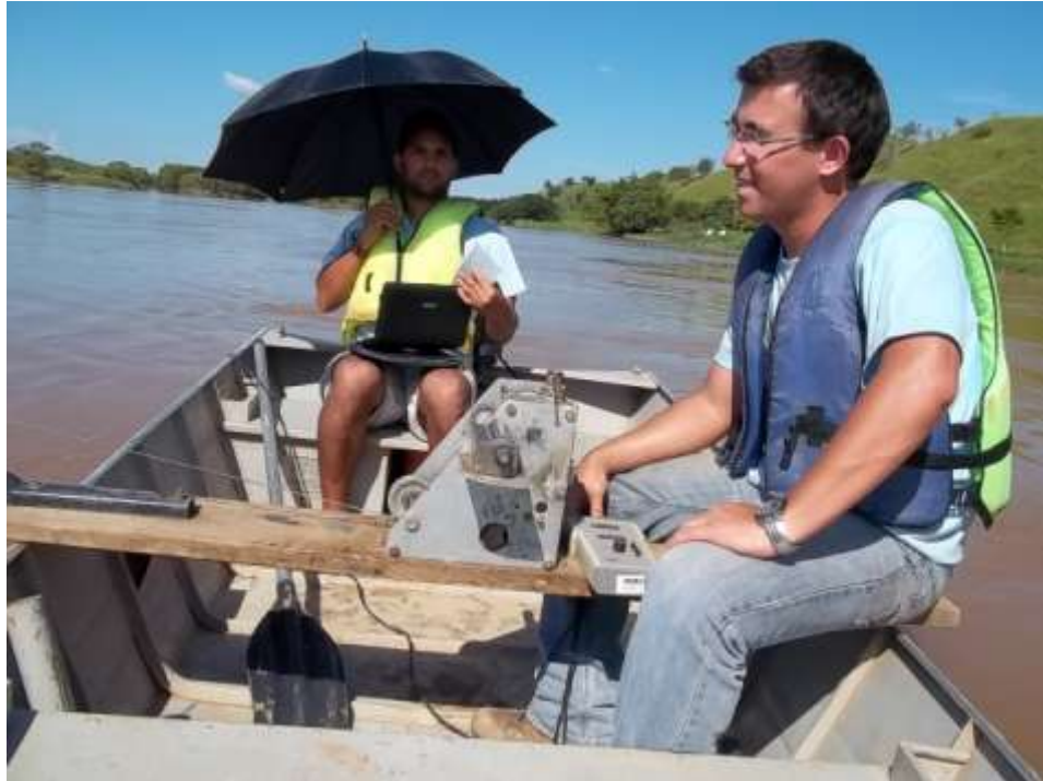
Foto 19 - Medição de descarga líquida realizada em 07-02-2012 na estação fluvio-sedimentométrica de Porto do Tuta no Paraíba do Sul.
