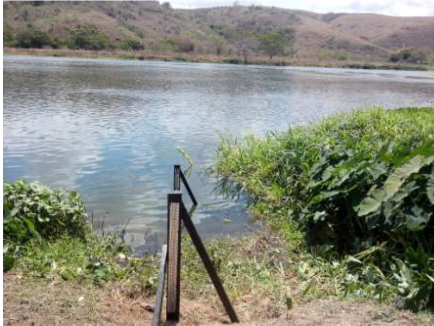
Figura 24 - Vista geral dos primeiros lances de régua da estação limnimétrica de Itaocara São Sebastião do Paraíba Montante no rio Paraíba do Sul
