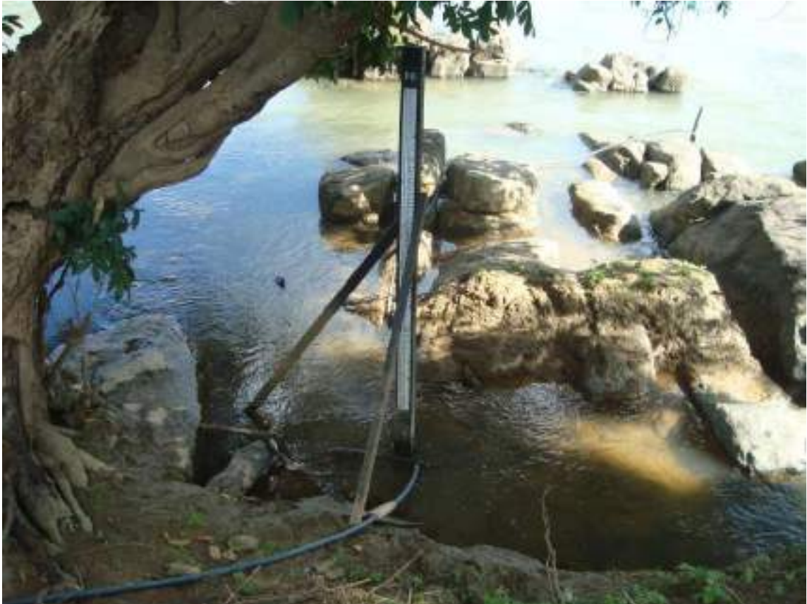
Foto 03 – Outro detalhe das régua na estação fluviométrica de Itaocara nos fundos da casa do Sr. José Luiz na margem esquerda do rio Paraíba do Sul.
