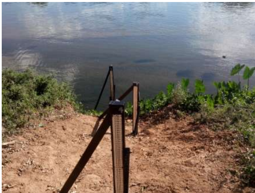
Figura 5 - Manutenção dos primeiros lances de réguas da estação limnimétrica de Itaocara I Canal da Fuga ME no rio Paraíba do Sul
