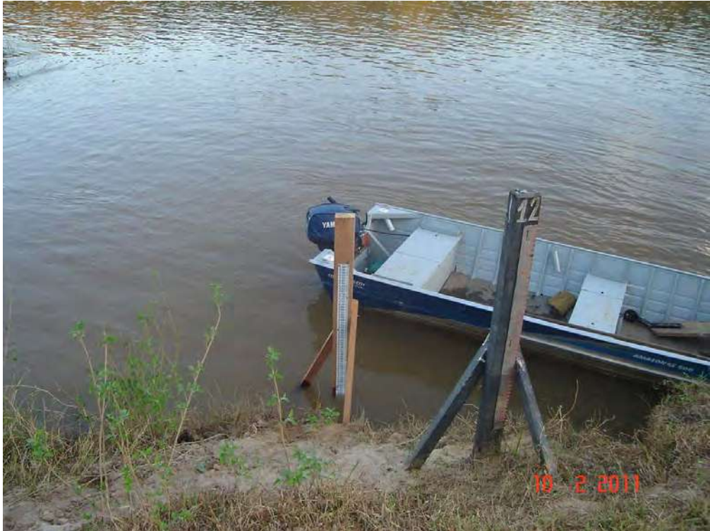
Foto 11 - Reinstalação do lance de réguas 09,00 a 11,00 da estação fluviométrica de Itaocara II Formiga Jusante.
