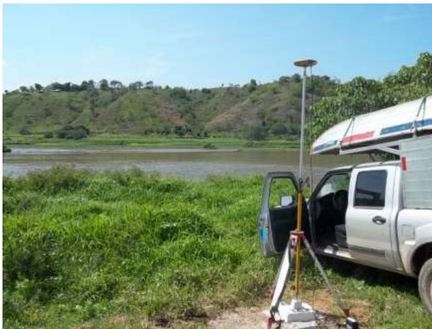
Foto 04 – Rastreamento com GPS da RN1 Itaocara | Montante Eixo para a RN1 da estação Itaocara | Roda D'água no rio Paraíba do Sul.
