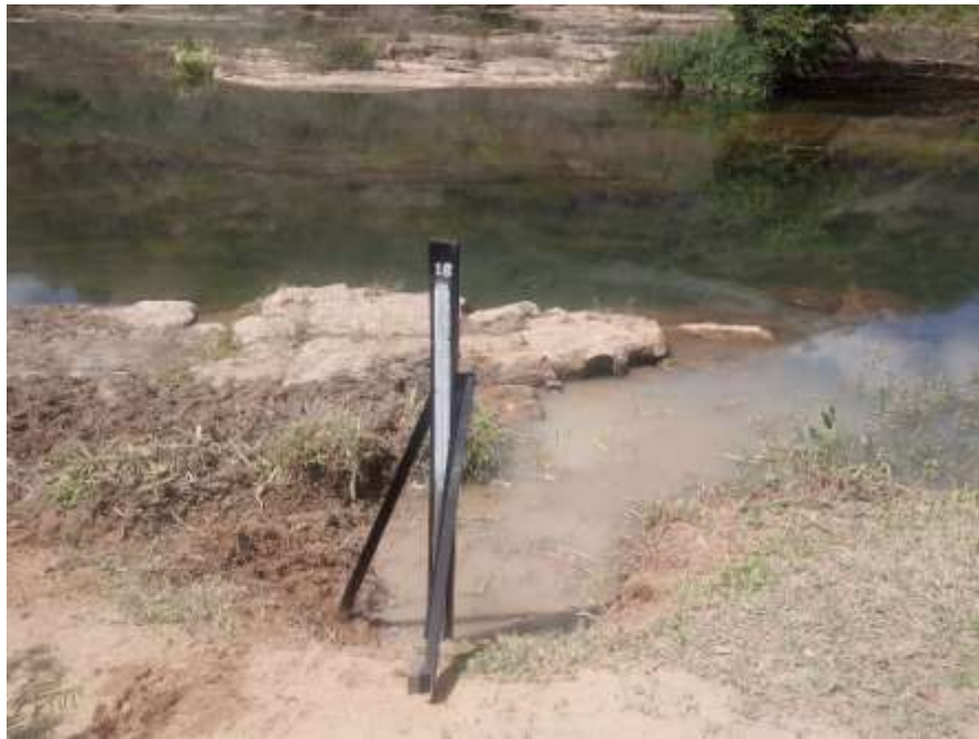
Figura 20 – Limpeza e manutenção do lance de régua 16/18 na estação limnimétrica de Itaocara Formiga Montante do rio Paraíba do Sul
