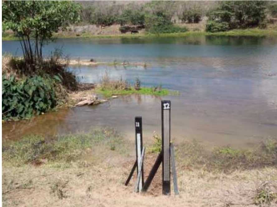
Figura 18 - Vista dos lances de réguas 10/11 e 11/12 após a manutenção da estação limnimétrica de Itaocara Formiga ME do rio Paraíba do Sul
