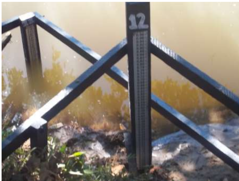
Figura 11 - Manutenção dos primeiros lances de régua da estação limnimétrica de Itaocara II São Sebastião do Paraíba no rio Paraíba do Sul
