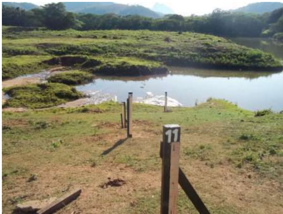
Figura 15 - Vista dos lances de régua após a manutenção da estação limnimétrica de Itaocara I Eixo MD do rio Paraíba do Sul.
