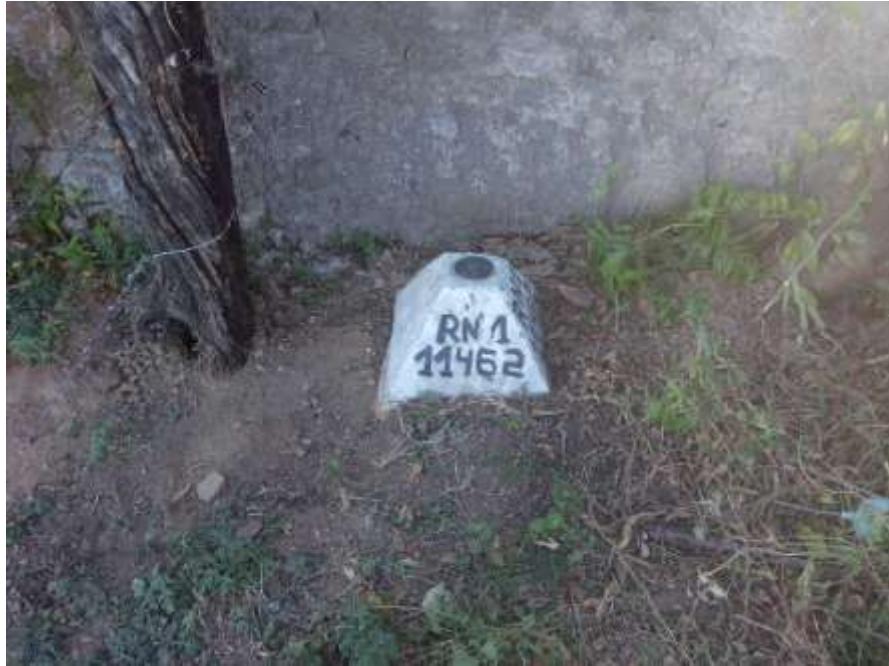
Figura 16 - Manutenção da RN1 da estação limnimétrica de Itaocara I Canal Direito Eixo MD do rio Paraíba do Sul
