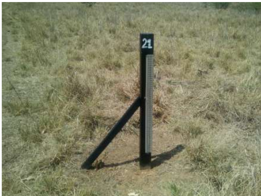
Figura 21 - Vista da manutenção do lance de régua 20/21 da estação limnimétrica de Itaocara Formiga Montante do rio Paraíba do Sul
