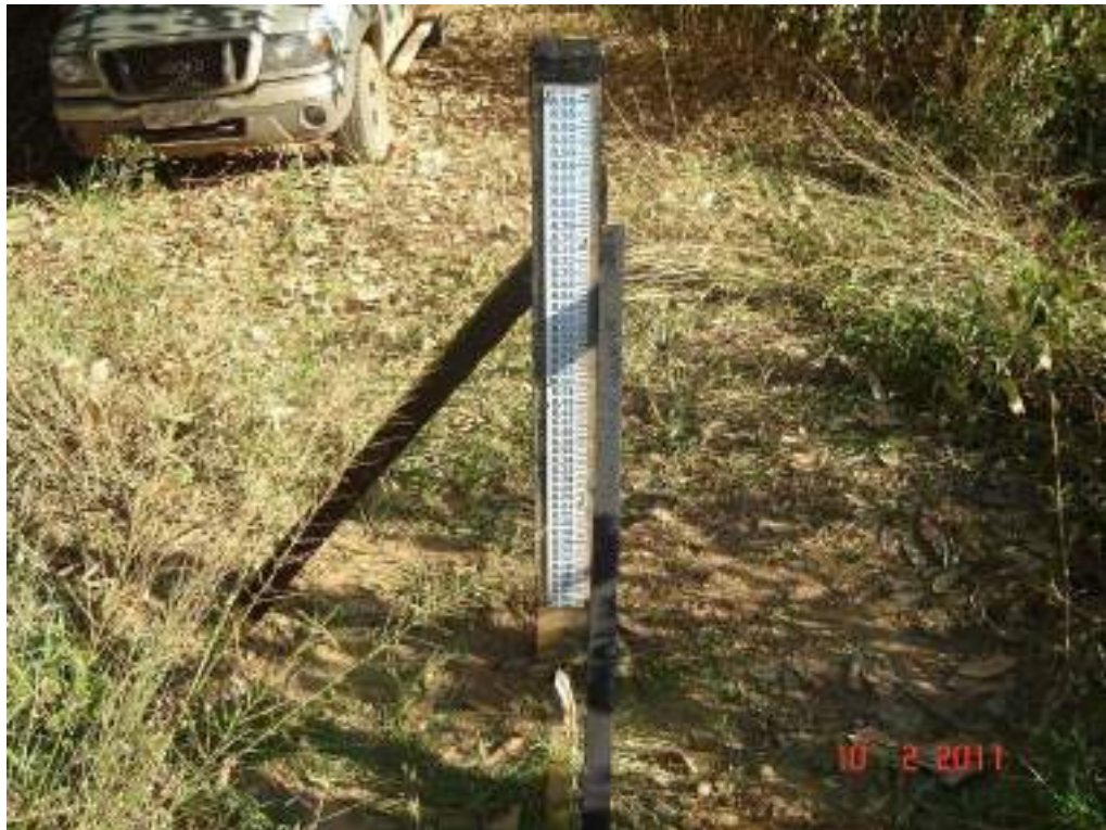
Foto 13 - Detalhe do lance de réguas 18,00 a 19,00 instalado na estação fluviométrica de Itaocara II Formiga Montante
