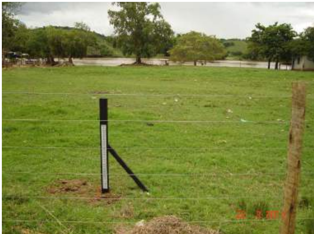
Foto 18 - Detalhe do último lance de régua da estação fluvio-sedimentométrica de Porto do Tuta, instalado próximo a estrada
