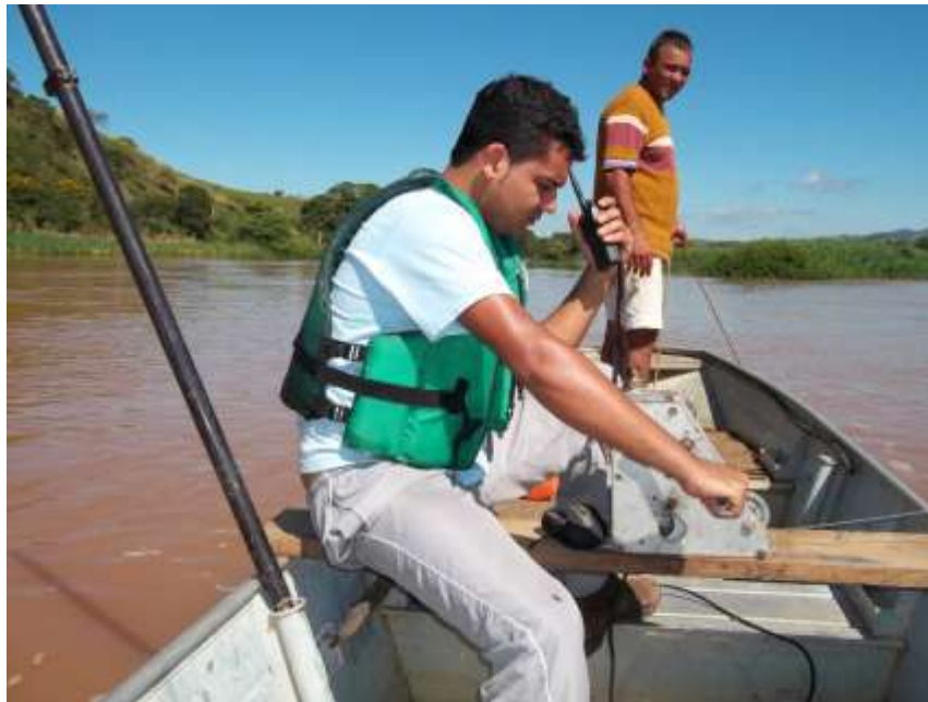
Foto 29 - Detalhe da medição de descarga líquida na estação fluviométrica Roda D'água no rio Paraíba do Sul em 03/05/2012.
