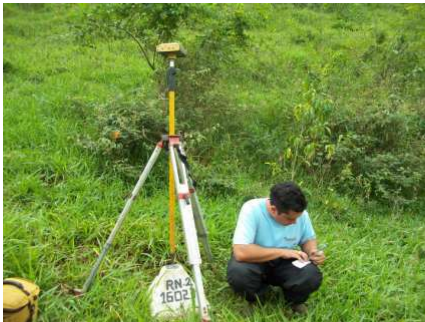
Foto 09 – Rastreamento com GPS da RN1 Itaocara I Montante para a RN1 da estação Itaocara II Canal Esquerdo Eixo ME.
