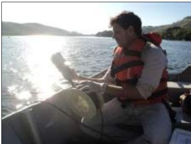
Figura 30: Medição de parâmetros físicos e químicos in situ com uso de sonda multiparâmetros, durante a execução do Programa.
