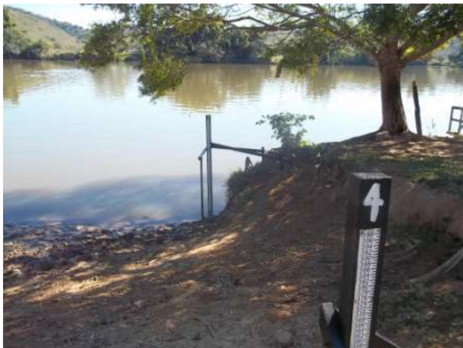
Figura 9 - Detalhe da manutenção das régua da estação fluviométrica de Itaocara I Porto do Tuta no rio Paraíba do Sul
