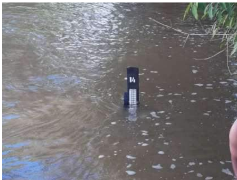
Figura 8 – Vista do lance de réguas 13/14 instalado no ponto denominada de Itaocara I Montante, no rio Rio Paraíba do Sul
