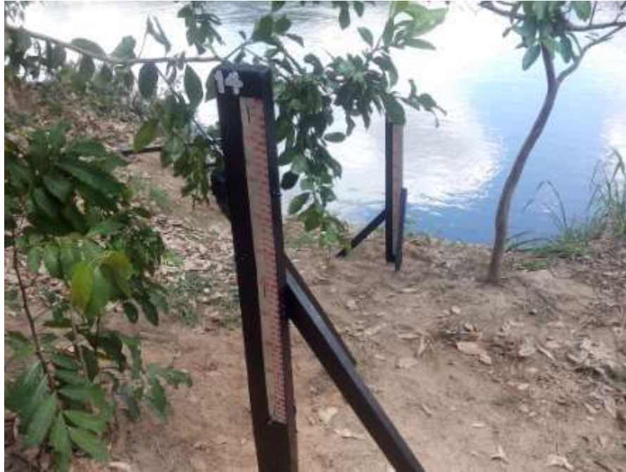
Figura 12 - Vista após a manutenção dos lances de régua da estação limnimétrica de Itaocara São Sebastião do Paraíba no rio Paraíba do Sul
