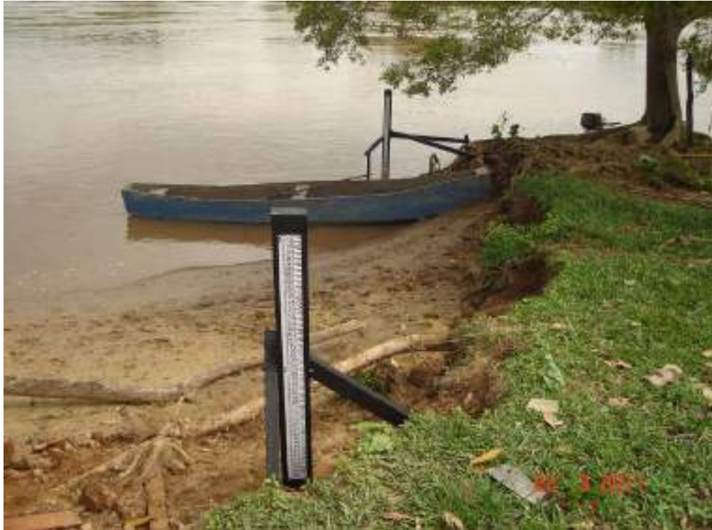
Foto 17 - Detalhe dos lances de régua instalados na estação fluvio-sedimentométrica de Porto do Tuta no rio Paraíba do Sul.
