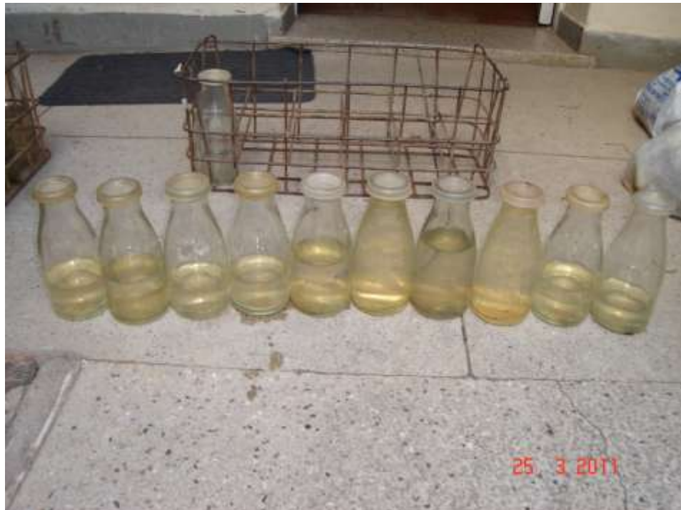
Foto 21 - Amostras de sedimento em suspensão da medição de descarga sólida realizada em 22-03-2011 na estação de Porto do Tuta no rio Paraíba do Sul.
