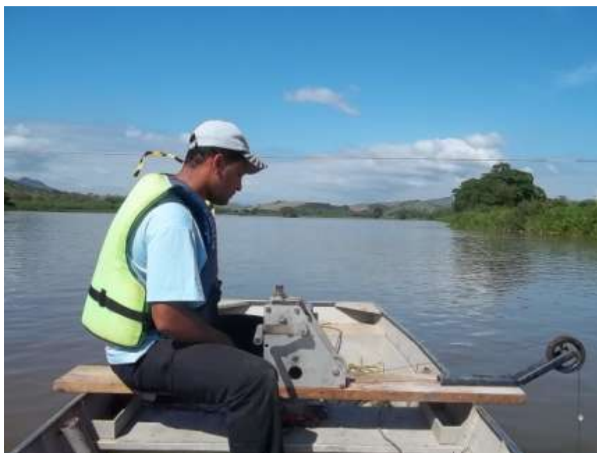
Foto 13 – Detalhe da medição de descarga líquida na estação Itaocara Roda D'água no rio Paraíba do Sul.
