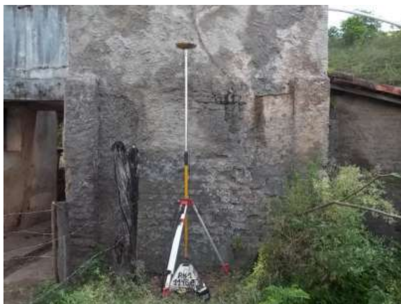
Foto 06 – Rastreamento com GPS da RN1 Itaocara Montante para a RN-1 da estação Itaocara Canal de Fuga MD.
