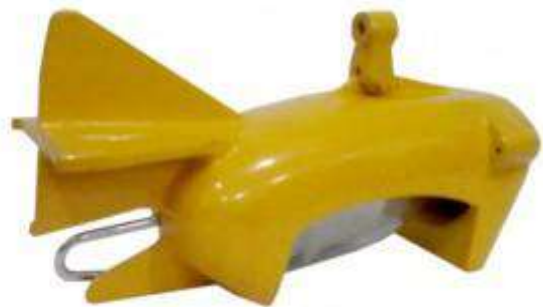
Fotos 5 e 6: Amostrador de Sedimento em Suspensão DH-59.
