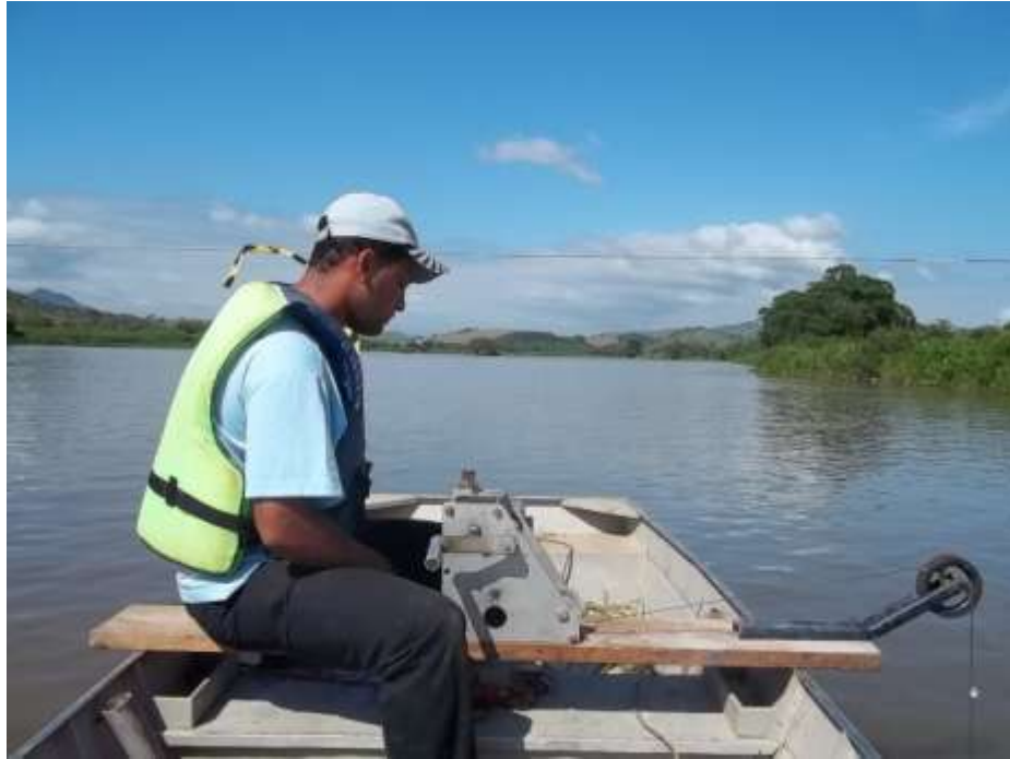
Foto 01 – Medição de descarga líquida na estação fluviométrica de Roda D'água no rio Paraíba do Sul em 05/11/2011.
