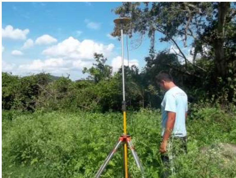
Foto 07 – Rastreamento com GPS da RN1 Itaocara Montante para a RN-1 da estação Itaocara Canal de Fuga ME.
