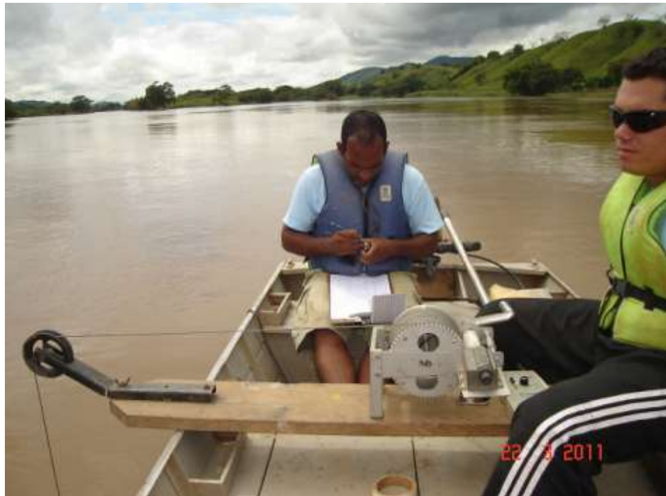
Foto 15 - Medição de descarga líquida realizada em 22-03-2011 na estação fluvio-sedimentométrica de Porto do Tuta no Paraíba do Sul.
