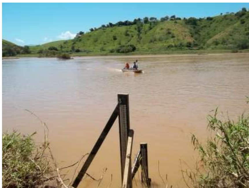
Foto 23 – Medição de descarga líquida na estação fluviométrica de Roda D'água no rio Paraíba do Sul em 07/02/2012.
