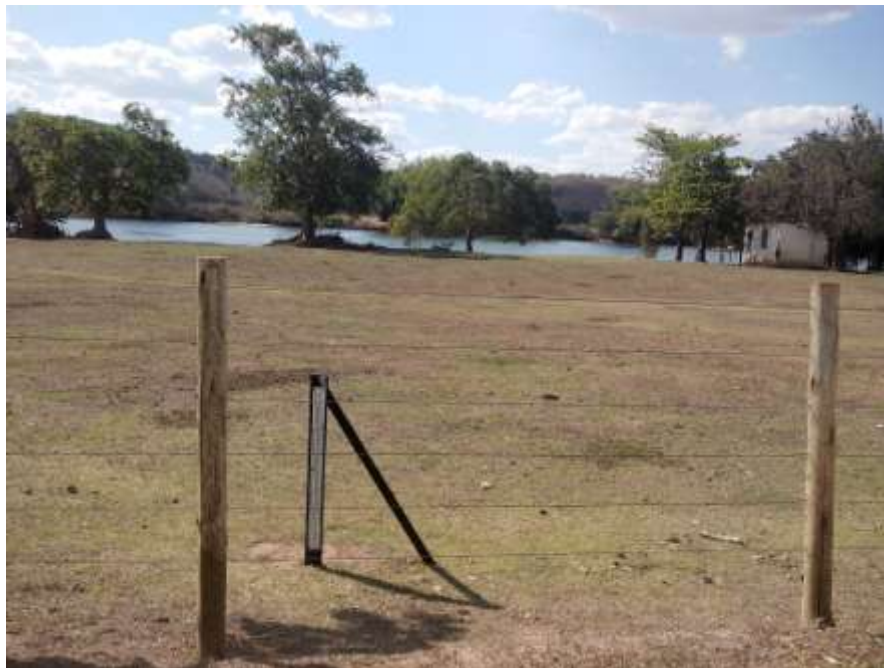
Figura 9 - Detalhe da manutenção das régua da estação fluviométrica de Itacara I Porto do Tuta no rio Paraíba do Sul
