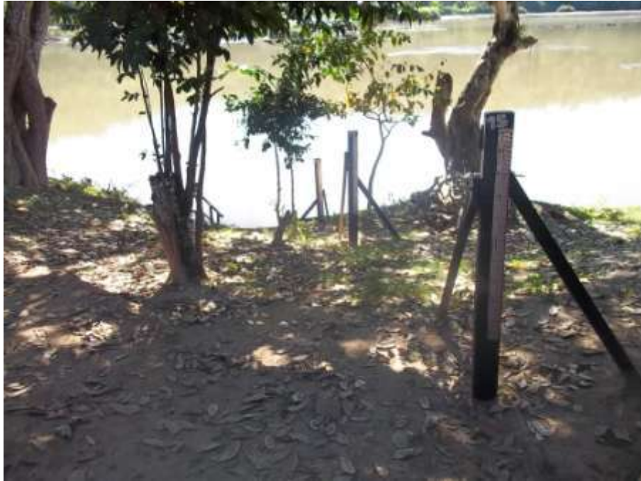
Figura 12 - Vista após a manutenção dos lances de régua da estação limnimétrica de Itaocara II São Sebastião do Paraíba no rio Paraíba do Sul
