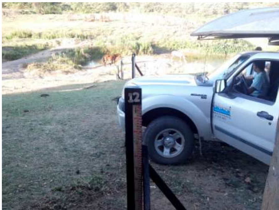
Figura 15 - Vista dos lances de régua após a manutenção da estação limnimétrica de Itaocara I Canal Direito Eixo MD do rio Paraíba do Sul.
