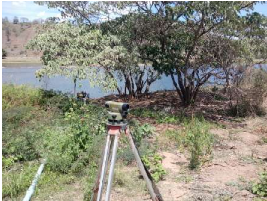
Figura 2 - Nivelamento dos lances de régua da estação fluviométrica de Itaocara I Roda D'água no rio Paraíba do Sul
