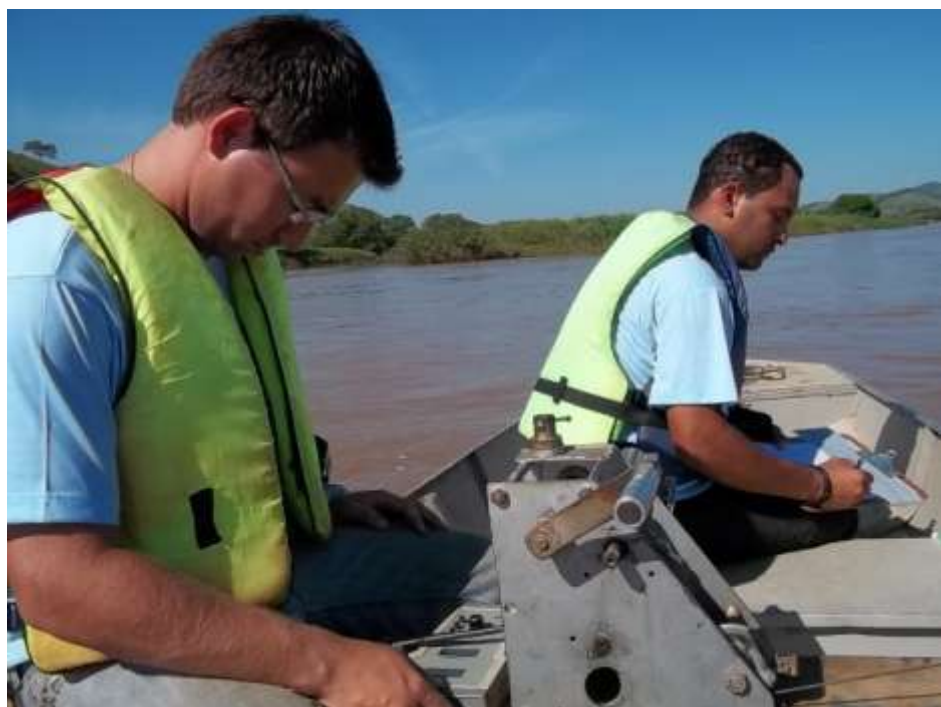
Foto 18 - Medição de descarga sólida realizada em 14-12-2011 na estação fluvio-sedimentométrica de Porto do Tuta no rio Paraíba do Sul.
