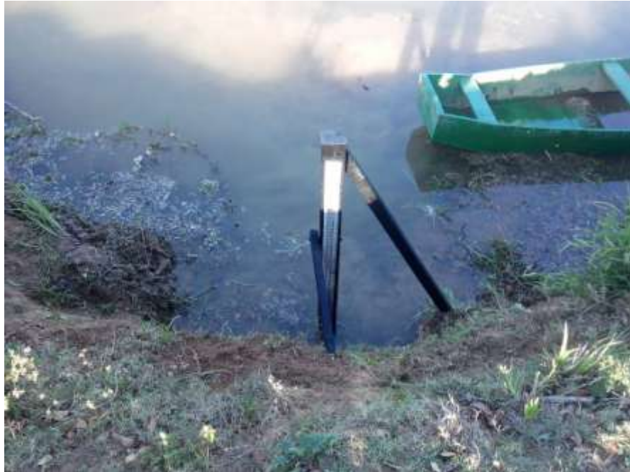
Figura 14 - Manutenção do primeiro lance de régua da estação limnimétrica de Itaocara I Canal Direito Eixo MD no rio Paraíba do Sul
