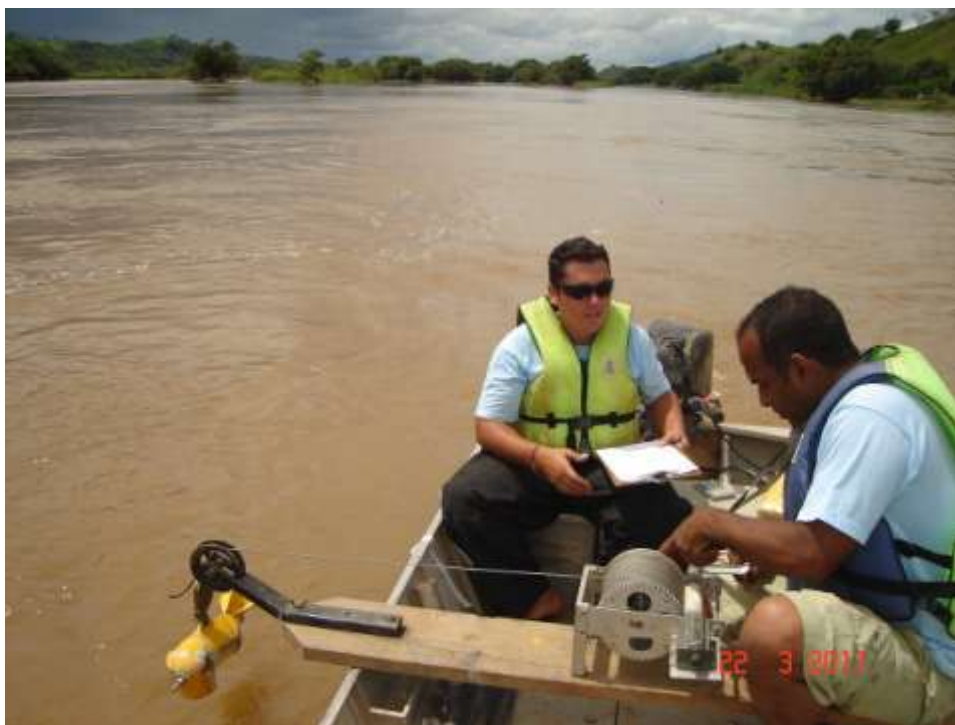
Foto 16 - Medição de descarga sólida realizada em 22-03-2011 na estação fluvio-sedimentométrica de Porto do Tuta no rio Paraíba do Sul.
