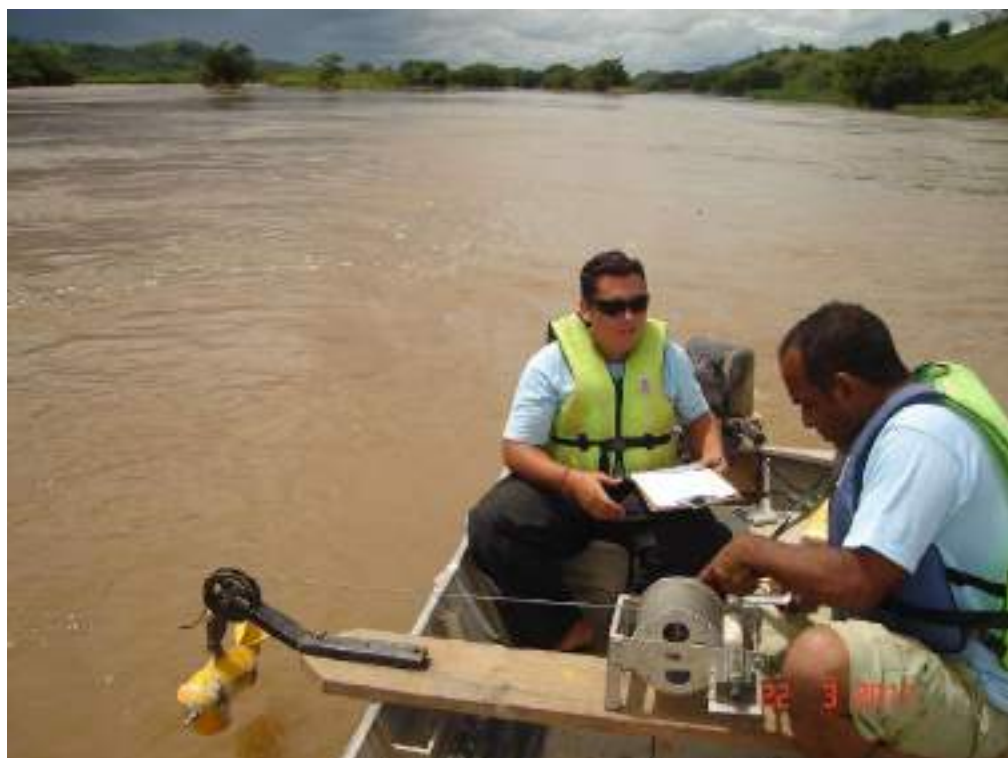
Foto 20 - Medição de descarga sólida realizada em 22-03-2011 na estação fluvio-sedimentométrica de Porto do Tuta no rio Paraíba do Sul.
