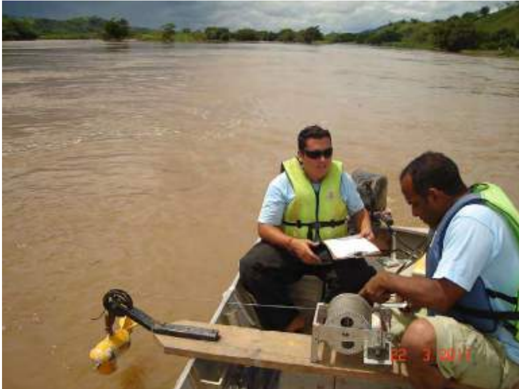
Foto 17 - Detalhe da medição de descarga sólida realizada em 22-03-2011 na estação fluvio-sedimentométrica de Porto do Tuta.
