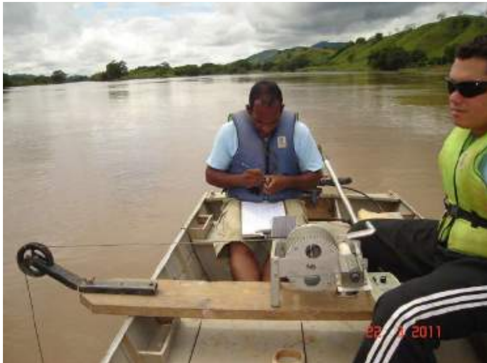
Foto 19 - Medição de descarga líquida realizada em 22-03-2011 na estação fluvio-sedimentométrica de Porto do Tuta no Paraíba do Sul.
