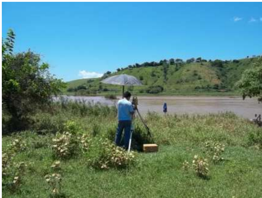
Foto 24 - Estação total posicionada na medição de descarga líquida na estação fluviométrica Roda D'água no rio Paraíba do Sul em 08/02/2012.
