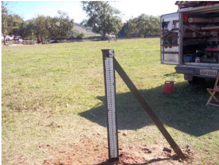
Figura 10 - Vista da manutenção do quinto lance de régua da estação fluviométrica de Itaocara I Porto do Tuta no rio Paraíba do Sul
