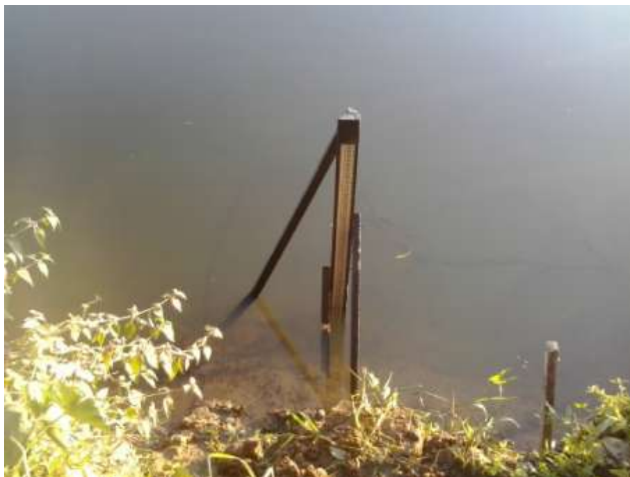
Figura 5 - Manutenção do primeiro lance de régua da estação limnimétrica de Itacara/ Canal da Fuga ME no rio Paraíba do Sul
