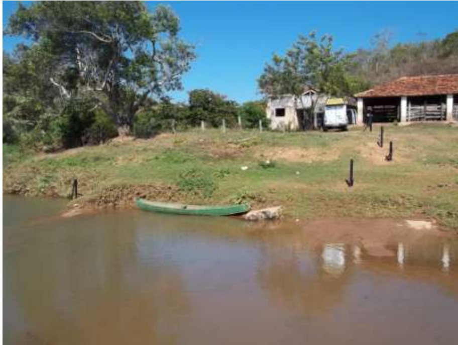
Figura 16 - Vista geral dos lances de régua após a manutenção da estação limnimétrica de Itaocara I Eixo MD do rio Paraíba do Sul
