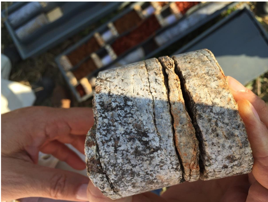
Figura 4.54 – Detalhe de Fratura Aberta e Oxidada no Maciço Rochoso.
