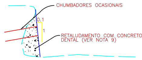
TRATAMENTO DE TALUDES NEGATIVOS (ALTERNATIVA DE PREENCHIMENTO COM CONCRETO DENTAL) (SEM BLOCOS OU PLACAS DESCOLADAS DO MACIÇO) SEM ESC.
