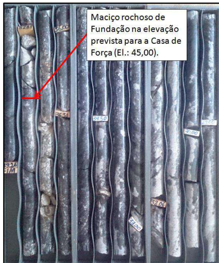
Figura 5.6 – Detalhe dos Testemunhos da Sondagem SR-112 Executada Sobre o Local de Implantação da Casa de Força, com 30° de Inclinação com a Vertical, Comprovando a Boa Qualidade Geomecânica e o Baixo Grau de Fraturamento na Elevação de Assentamento da Estrutura de Concreto
