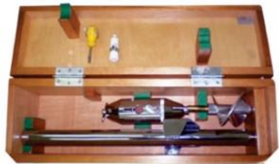
Foto 10: Molinete Fluviométrico MLN-7C.
