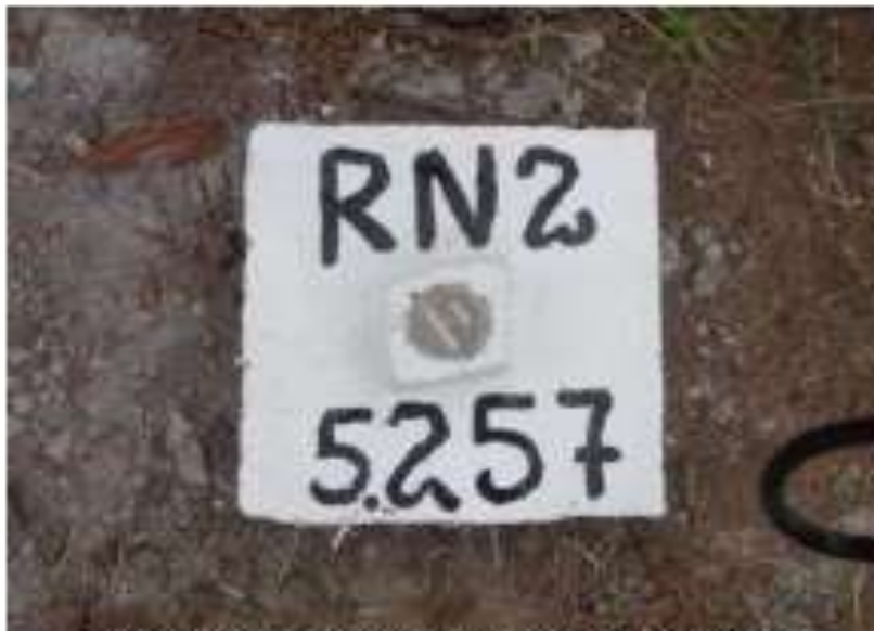
Detalhe do RN2 da estação fluviométrica Itaocara Roda D'água.
