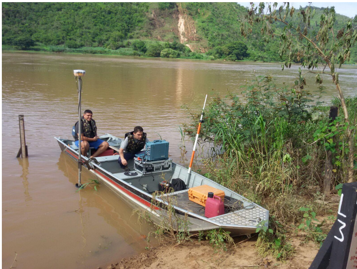
FIGURA 8 - EMBARCAÇÃO E SISTEMA BATIMÉTRICO COM RTK.
