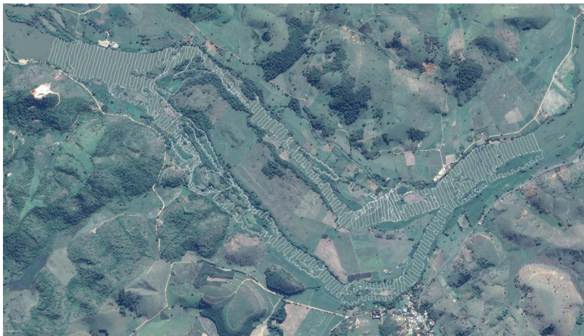
FIGURA 9 - SEÇÕES BATIMÉTRICAS LEVANTADAS EM CAMPO.
