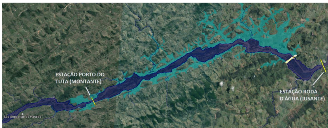
Figura 3-I: Localização das estações fluviossedimentométricas da UHE Itaocara
