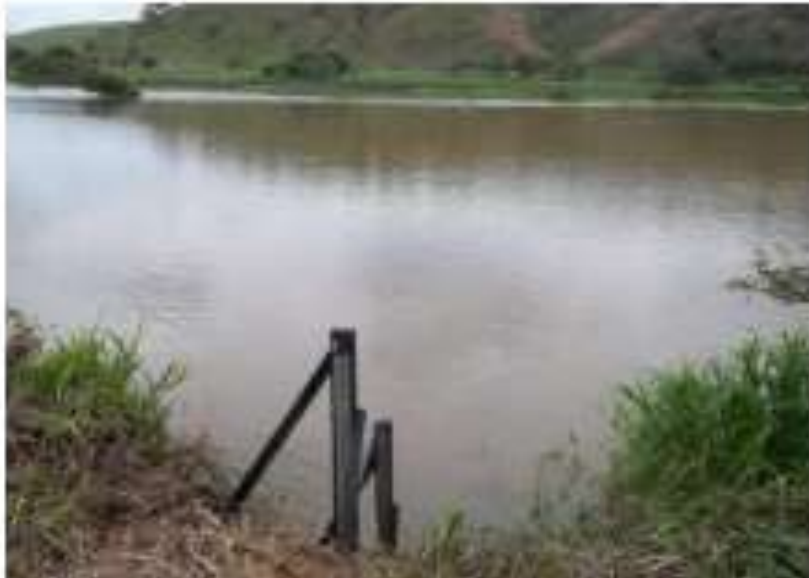
Lances de régua e sessão de medição da estação fluviométrica Itaocara Roda D'água.
