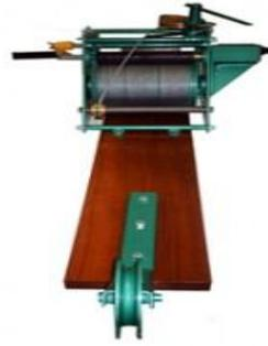
Fotos 7: Contador de Pulsos Digital CPD-10. Foto 8: Guincho Fluviométrico Completo GFL-15.
