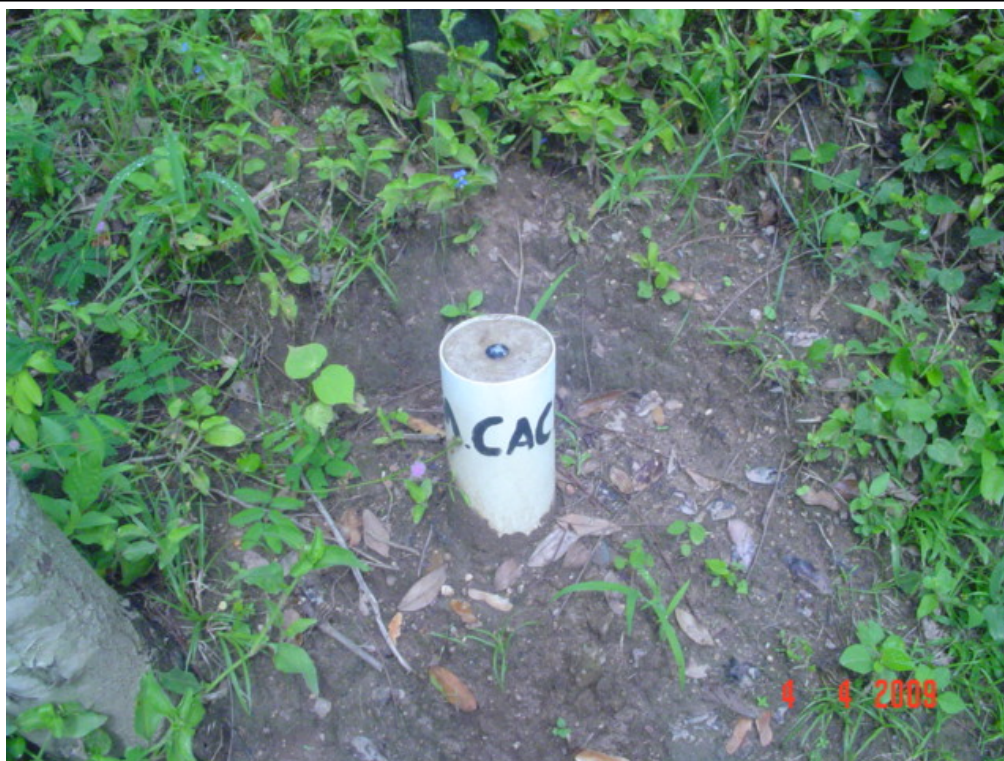
Foto 3. Marco PVC Montante Cachoeira da Cohidro - MCACH(COH) .
