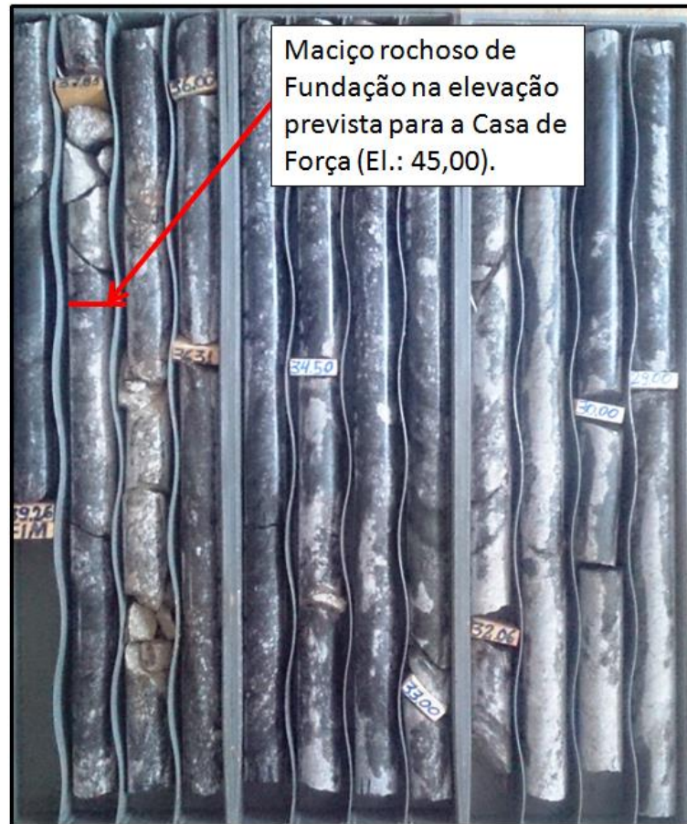
FOTO 2 – Detalhe dos testemunhos da sondagem SR-112 executada sobre o local de implantação da Casa de Força, com 30° de inclinação com a vertical, comprovando a boa qualidade geomecânica e o baixo grau de fraturamento nas elevações de assentamento da estrutura de concreto.
