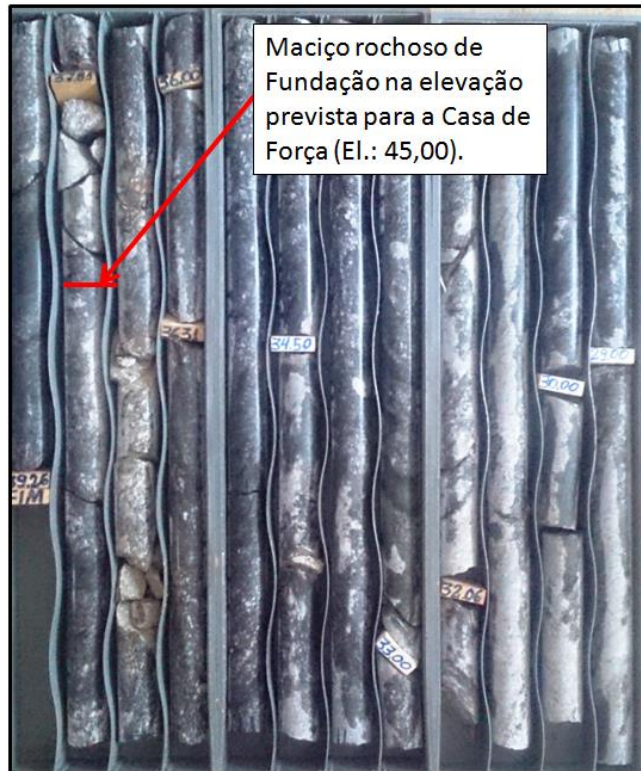
FOTO 1 – Detalhe dos testemunhos da sondagem SR-112 executada sobre o local de implantação da Casa de Força, com 30° de inclinação com a vertical, comprovando a boa qualidade geomecânica e o baixo grau de fraturamento nas elevações de assentamento da estrutura de concreto.
