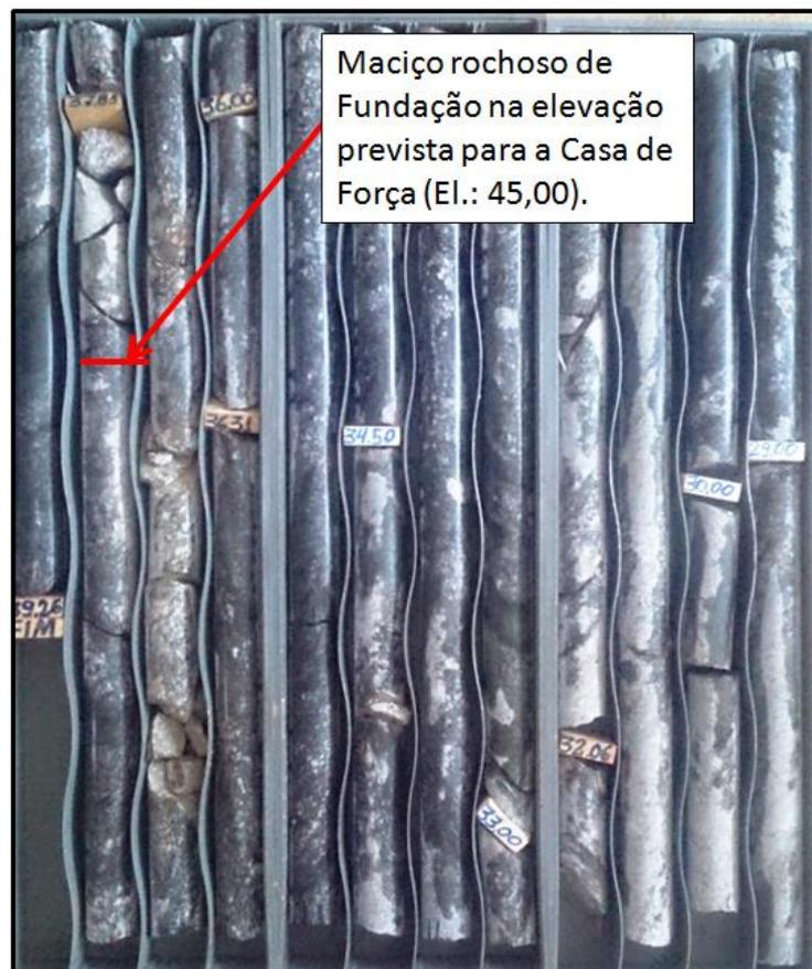
Figura 5.6 – Detalhe dos Testemunhos da Sondagem SR-112 Executada Sobre o Local de Implantação da Casa de Força, com 30º de Inclinação com a Vertical, Comprovando a Boa Qualidade Geomecânica e o Baixo Grau de Fraturamento na Elevação de Assentamento da Estrutura de Concreto
