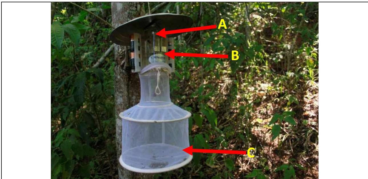
Figura 272: Armadilha luminosa CDC para captura de pequenos insetos noturnos. As setas indicam a posição da fonte luminosa (A), ventoinha (B) e bolsa coletora (C). Data: Mar/19.
